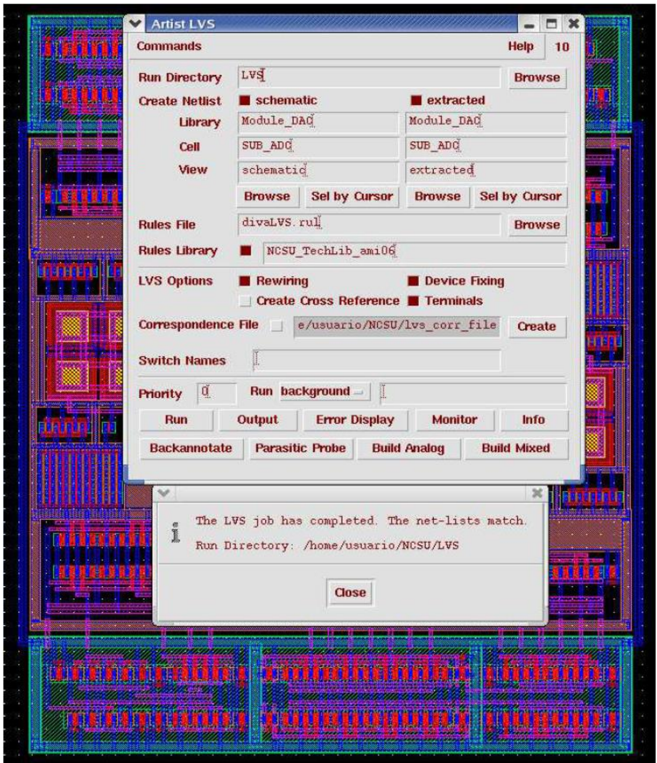
Fig. A-65 Resultados de comparación esquemático versus layout (verificación LVS), el circuito layout coincide con el circuito esquemático.
