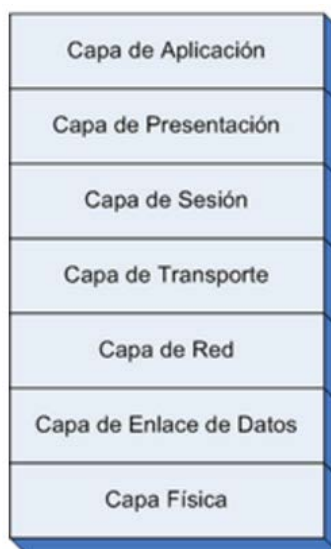
Ilustración 1 - Capas del modelo de referencia OSI
