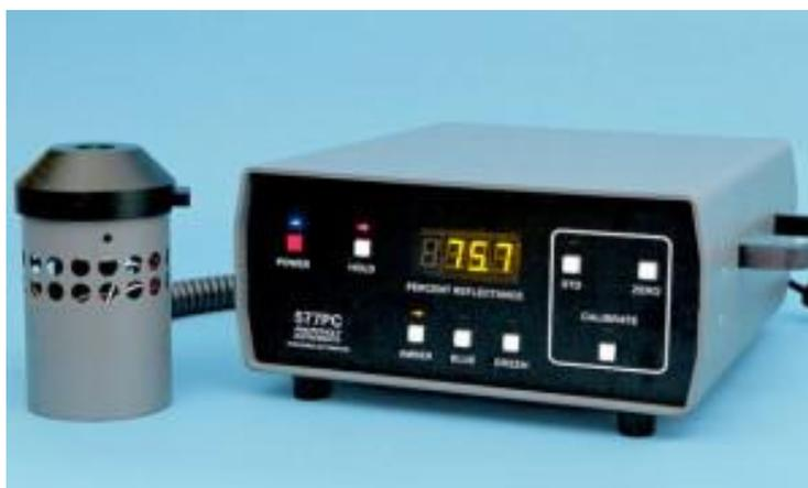
Se cuenta también con un instrumento de la marca Hunterlab y que utiliza la escala de color en base a los parámetros CIE L, a y b, y el concepto se basa en la claridad y las dimensiones de los oponentes de color
