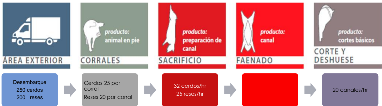
Ilustración 32 Descripción de la capacidad de sacrificio y corte para el dimensionamiento. Elaboración propia con datos GBPD UNAM-SENASICA
