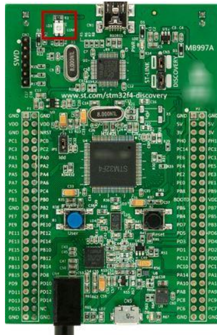
Figura 16. Tarjeta de Desarrollo para CORTEX-M4 para emular la recepción de paquetes de actualización
