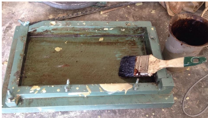
Fig. 37 Placa metálica, untada con aceite de motor y tornillos correctamente apretados.
