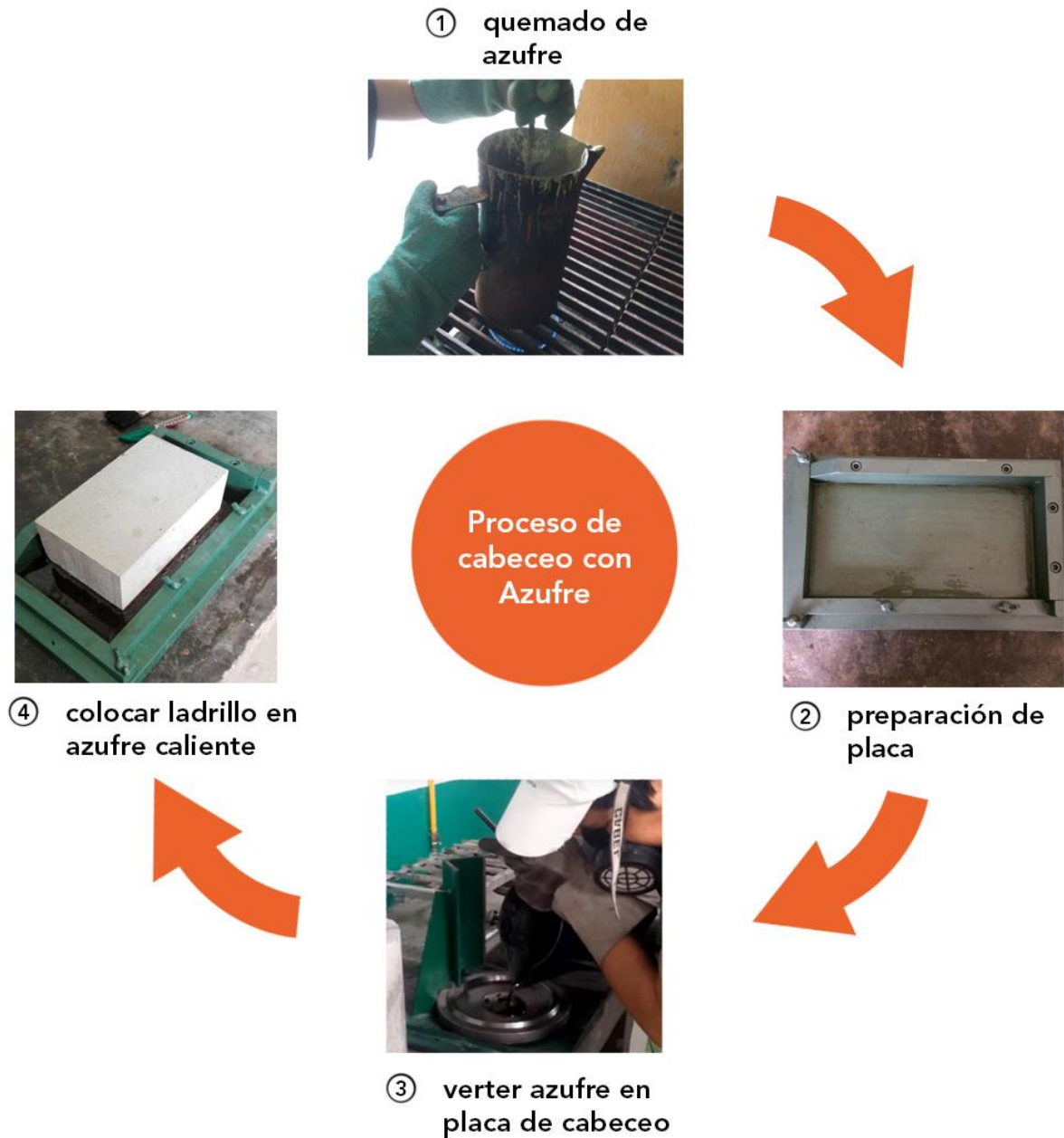
Fig. 34 Proceso de cabeceo de ladrillos con azufre. Fuente (Imagen propia PAP).
