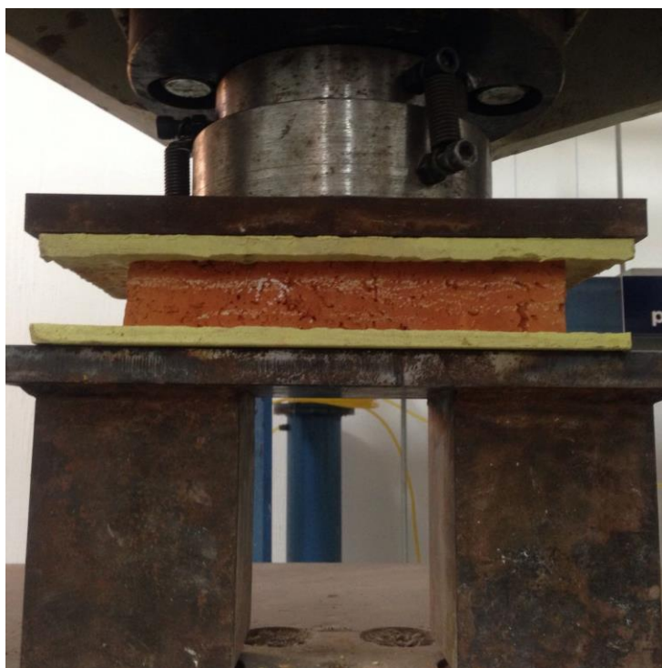
Fig. 7 Imagen que muestra el acomodo del ladrillo cabeceado dentro del compresor.
