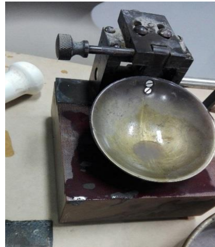
Fig. 27 Copa de Casagrande, utilizada para obtener los límites de Atterberg.
