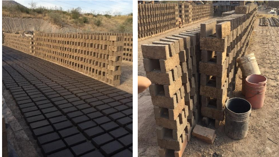
Fig. 32 Área de secado en la ladrillera ubicada en Tlajomulco de Zúñiga. Fuente (Imagen propia PAP)
