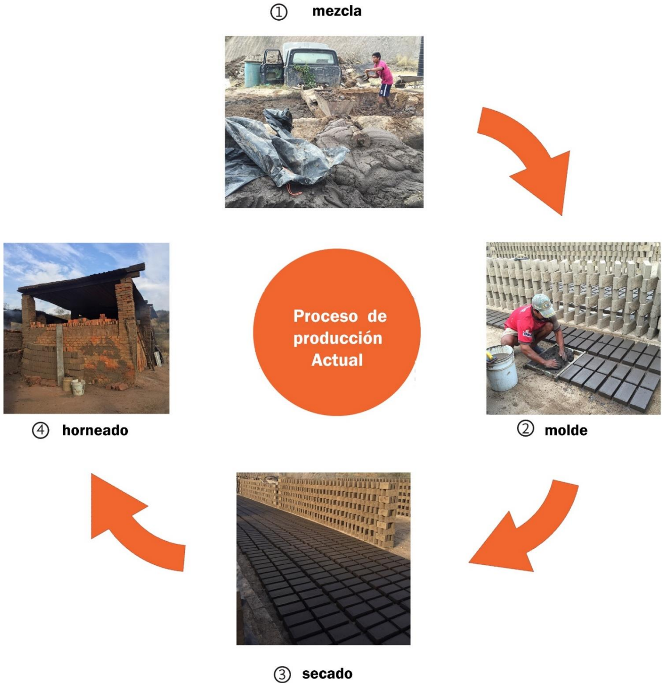
Fig. 29 Proceso de producción actual de ladrillo. Fuente: Diagrama tomado de Reporte final PAP Ladrilleras Verano 2016
