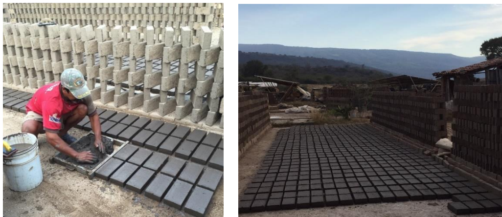
Fig. 31 Área de moldeado en la ladrillera ubicada en Tlajomulco de Zúñiga. Fuente (Imagen propia PAP)
