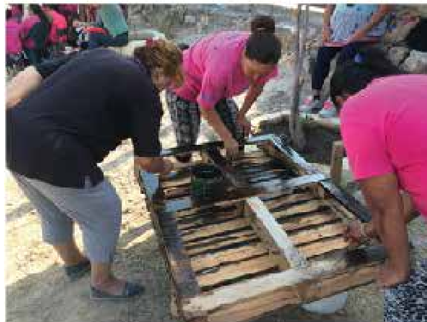
Imagen 92. Barnizamiento de tarimas con aceite quemado. Foto por Sarahí torres.
