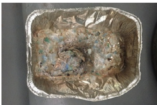
Figura 4.7. PET fundido en recipiente de aluminio
