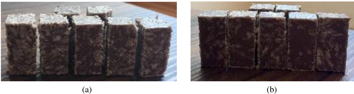
Figura 5.1. Especímenes realizados a una temperatura de 175°C; (a) 33% PET 33% PEAD 33% PP y (b) 20% PET 35% PEAD 45% PP.
