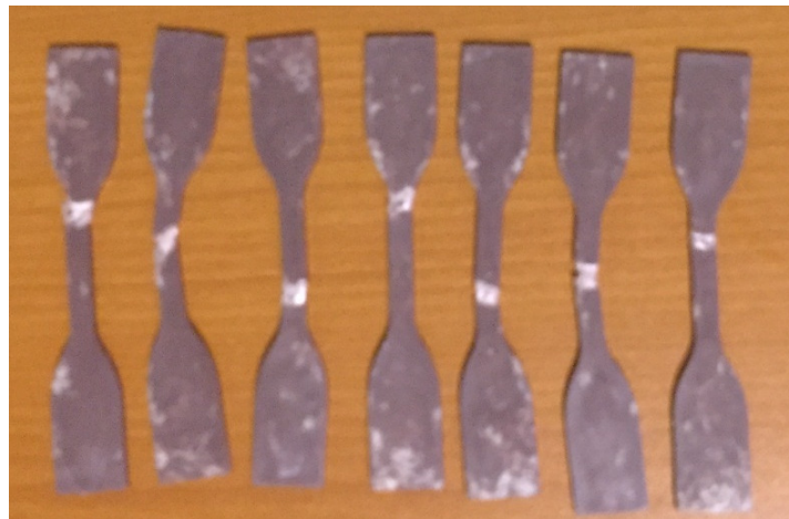
Figura 5.10. Especímenes sometidos a pruebas de tensión.
