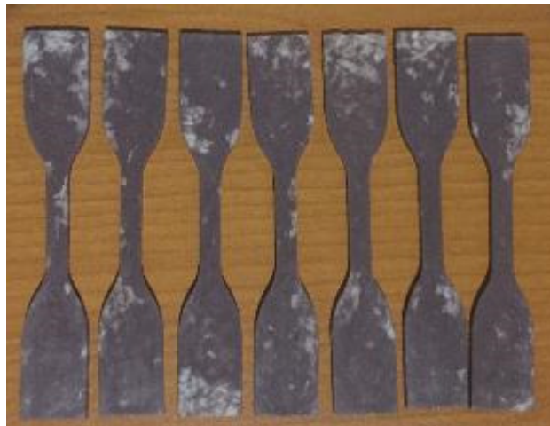
Figura 5.8. Especímenes para ser probados a la tensión.
