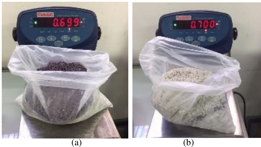
Figura A4.1. Mezclas de plásticos; (a) 33% PET 33% PEAD 33% PP y (b) 20% PET 35% PEAD 45% PP.
