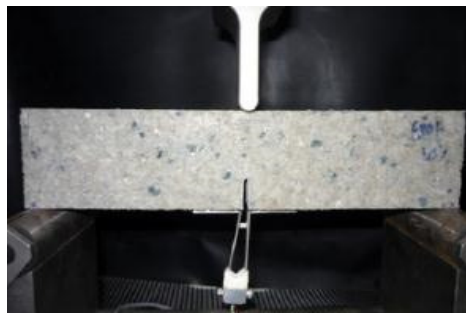
Figura 3.1. Preparación de prueba de fractura (Reis et al. , 2011).
