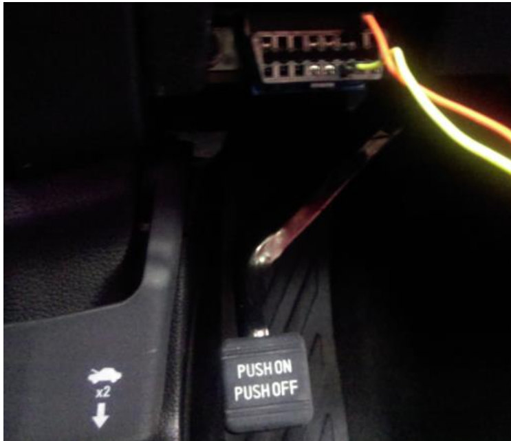
Fig. 4- 4. Conexión a conector OBD en automóvil.
