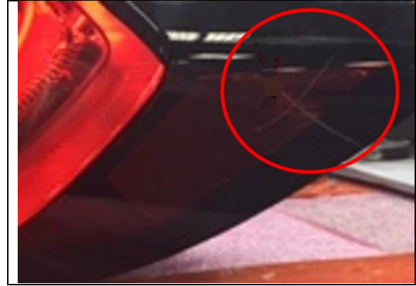
Figura 2. Luz trasera con falla
