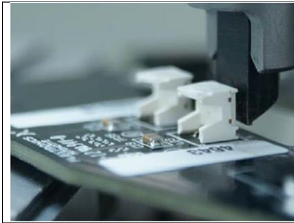
Figura 31. Prueba de esfuerzo cortante
