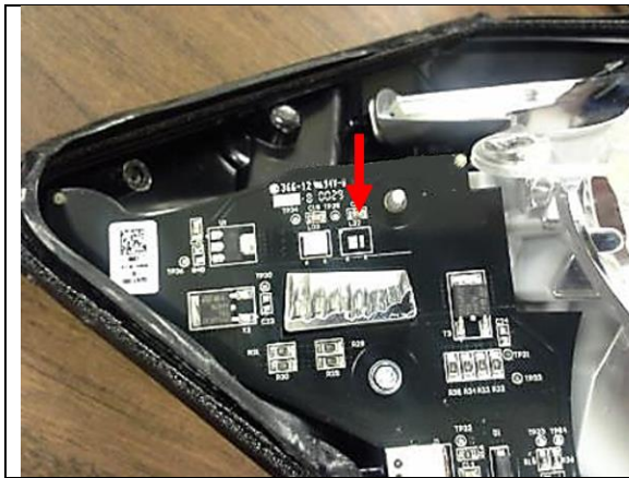
Figura 3. PCB con LED faltante
