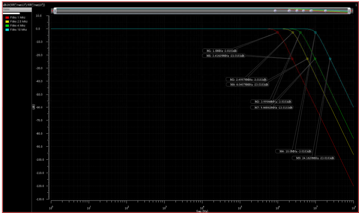
Fig. 3-106 Gráficas de la ganancia para los filtros (realización A.1) con G_m igual a 1, 2.5, 4 y 10.
