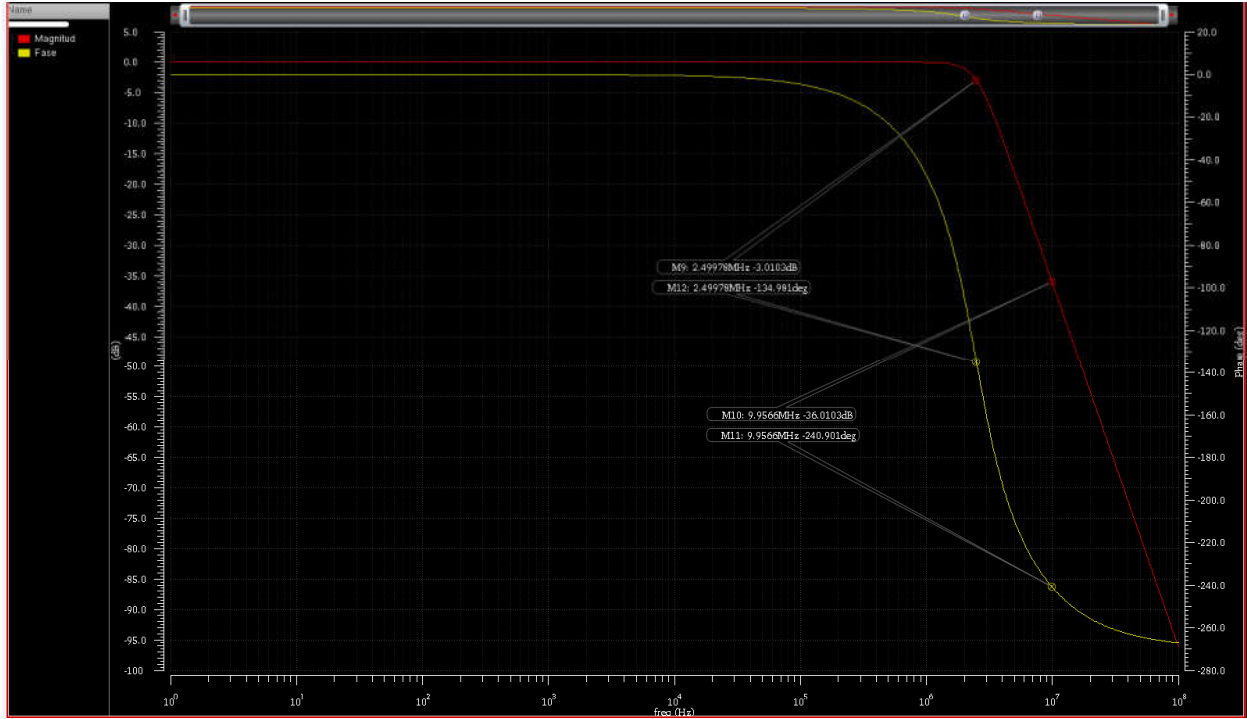
Fig. 3-89 Magnitud y fase del filtro caso 2 – realización A.1 con G_m = 250 [ \mu S ].
