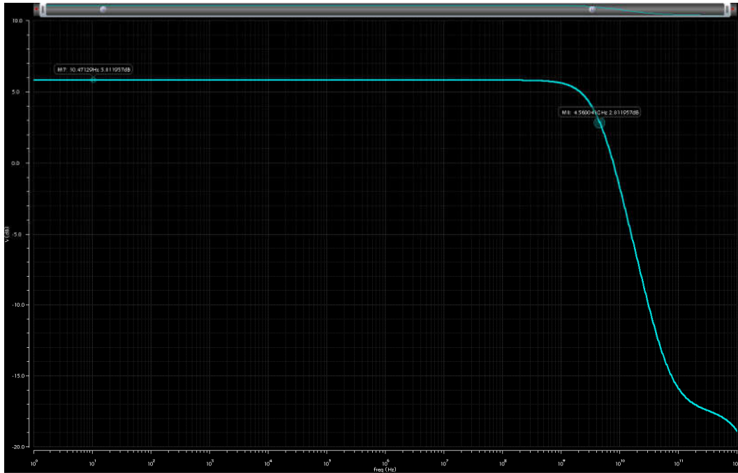
Fig. 3-16 Respuesta en frecuencia del OTA con W = 4 \text{ } [\mu\text{m}] , R_L = 1591.55 \text{ } [\Omega] , g_m = 1574.29 \text{ } [\mu\Omega^{-1}] , A_{v-sim} = 5.812 \text{ } [\text{dB}] y BW_{sim} = 4.56 \text{ } [\text{GHz}] .
