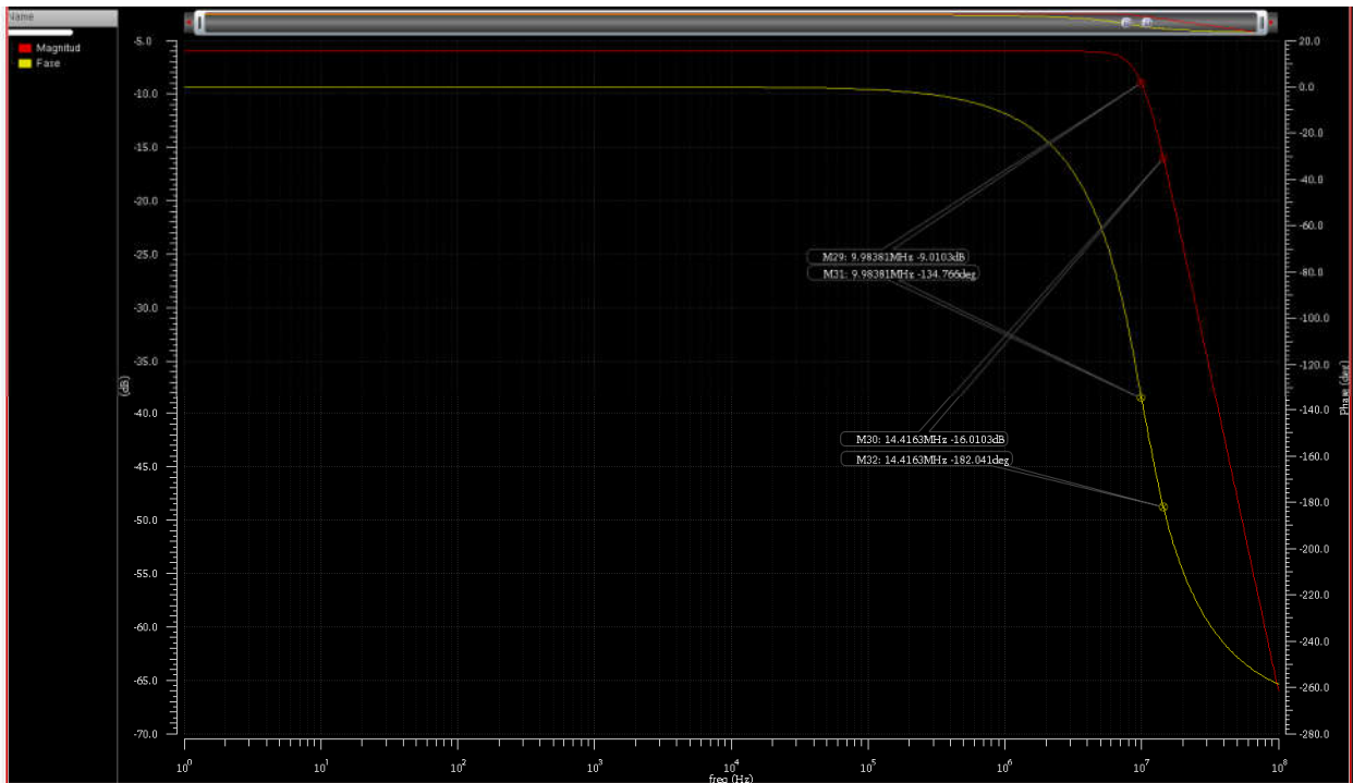
Fig. 3-84 Magnitud y fase del filtro del caso 4 – realización A.5 implantado con OTA-C .
