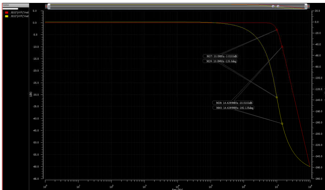
Fig. 3-61 Respuesta en frecuencia del filtro pasivo del caso 4 de acuerdo con la configuración A.1 propuesta en el Anexo A del libro de L. P. Huelsman.
