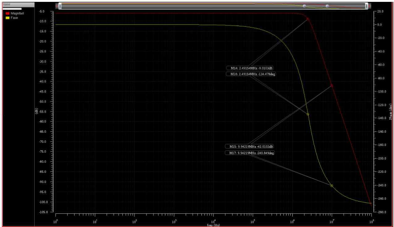
Fig. 3-100 Magnitud y fase del filtro caso 2 – realización A.5 con G_m = 250 [\mu S] y R_{out} = 4 [M\Omega] .
