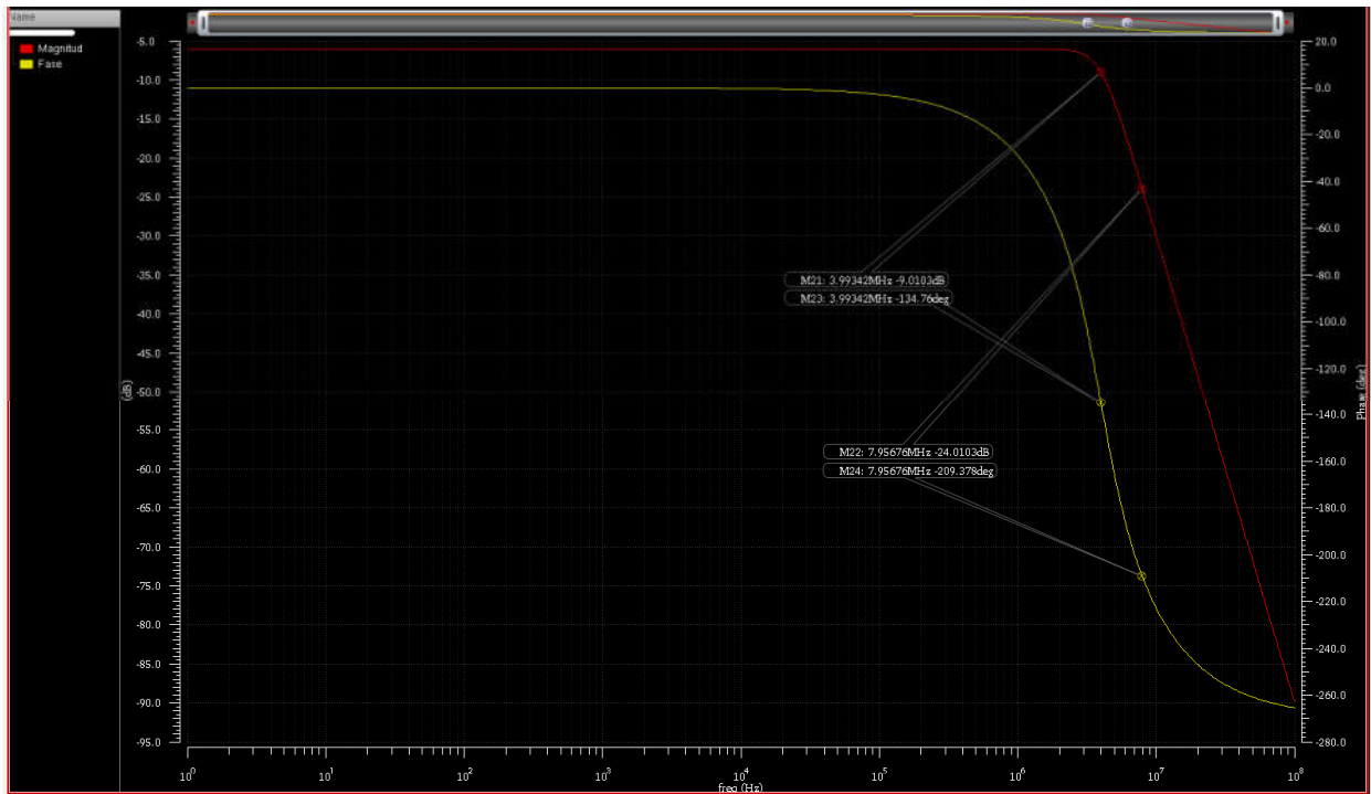
Fig. 3-82 Magnitud y fase del filtro del caso 3 – realización A.5 implantado con OTA-C .
