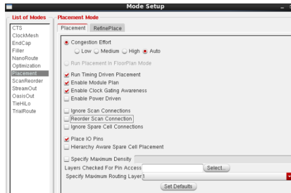
Figura 89: Opciones para colocación de las celdas estándar
