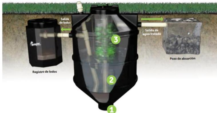
**Ilustración 59 Funcionamiento biodigestor Fuente: <http://rotoplas.com.mx>**
