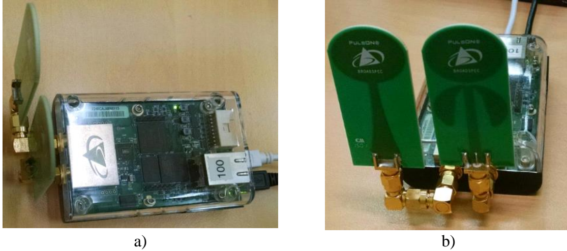
Fig. 4.2 UWB device: a) upper part, b) frontal part with antennas.
