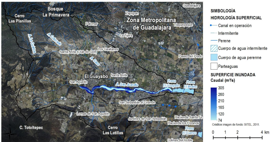
Figura 63. Superficie de inundación en función del caudal. Fuente: Elaboración propia con datos de INEGI y CEA (2011)
