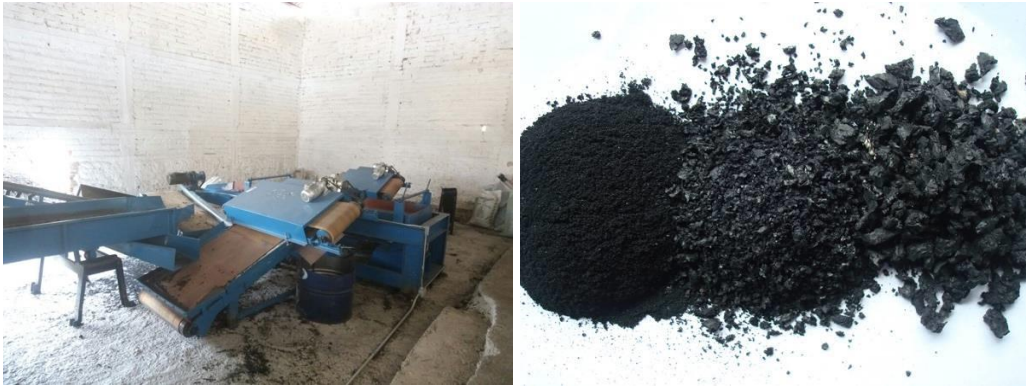
Figura 11. Bandas magnéticas separadoras de componentes y producto terminado de acuerdo a especificaciones del cliente
