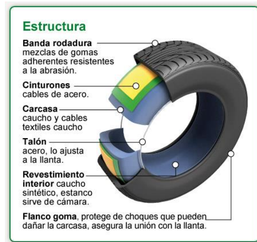
Figura 15. Estructura de una llanta
