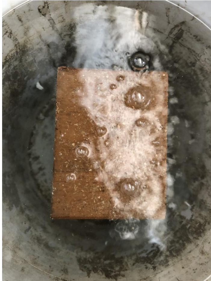
Ilustración 30 BTC sumergido en agua para prueba de absorción
