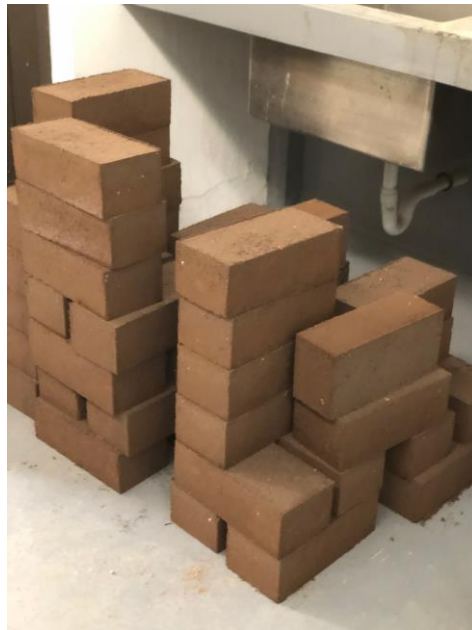
Ilustración 33 Producción de BTC para ensayos.
