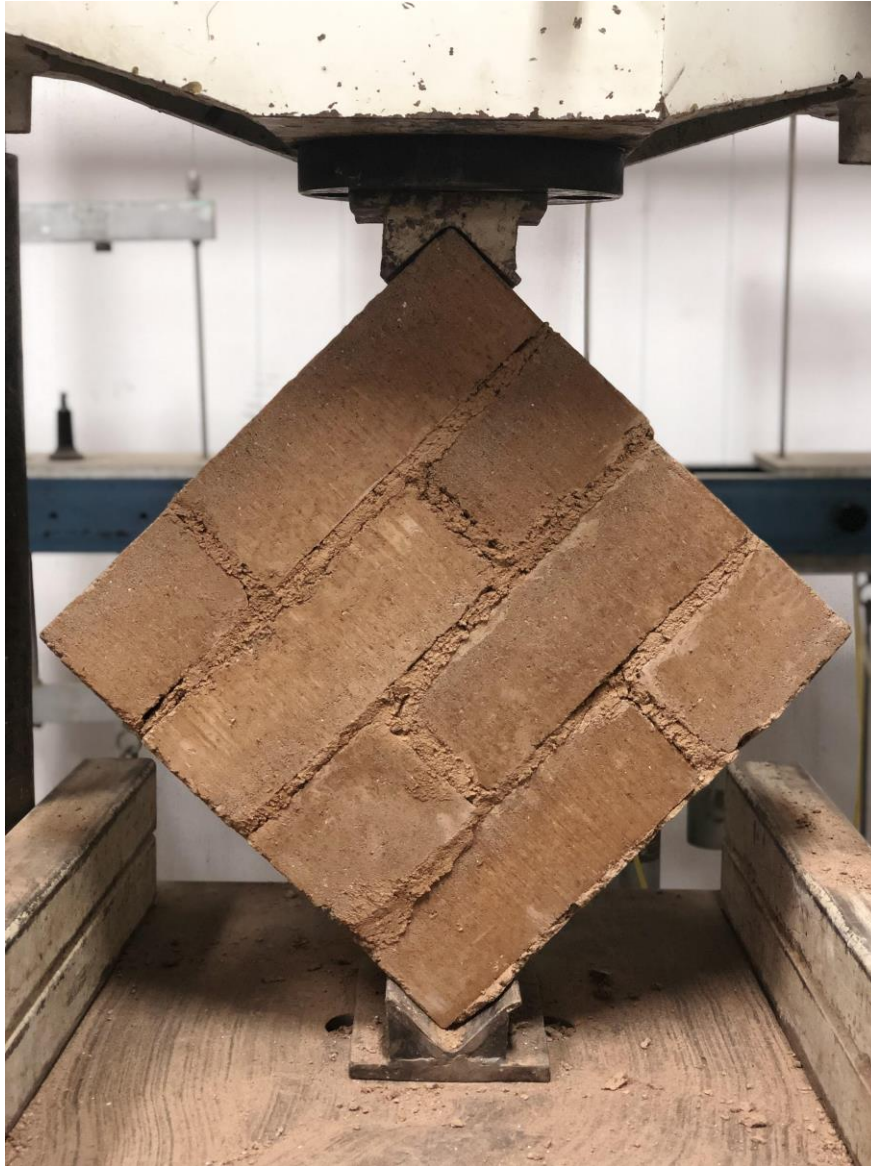
Ilustración 27 Murete en prueba de compresión diagonal
