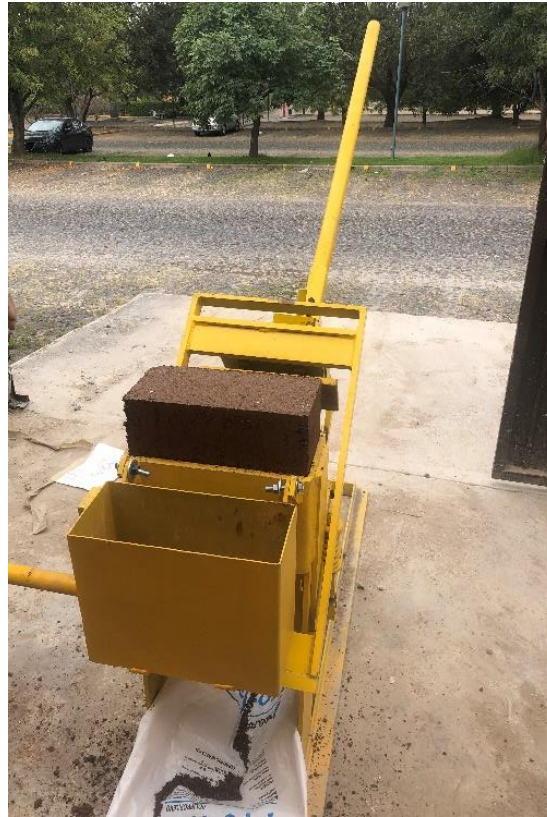
Ilustración 32 Maquina para producción de BTC. Fuente Elaboración propia.
