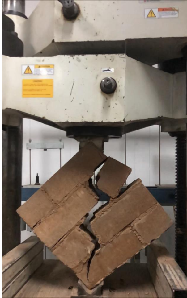
Ilustración 28 Falla de murete
