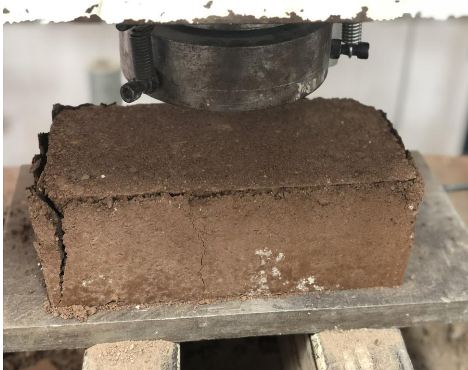
Ilustración 24 BTC con falla separación de caras Fuente: Elaboración propia
