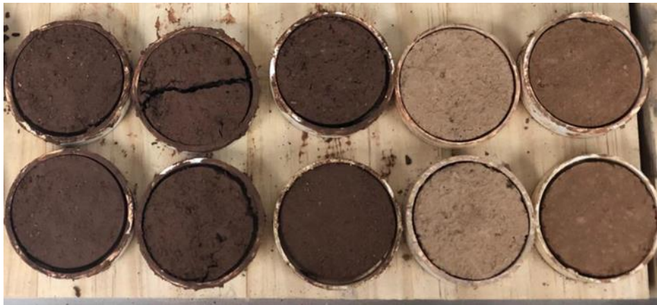
Ilustración 22 Muestras de tierra estabilizada con arena y cal. Fuente: Elaboración propia.
