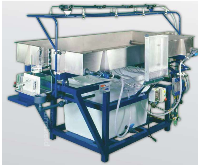
Figura 5.7 Simulador de lluvia S12MKII. Fuente: (Armfield, s.f.)
