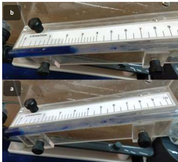
Figura 5.11 Registro de caudales de salida Q (l/min): a) al iniciar; b) al terminar. Fuente: elaboración propia
