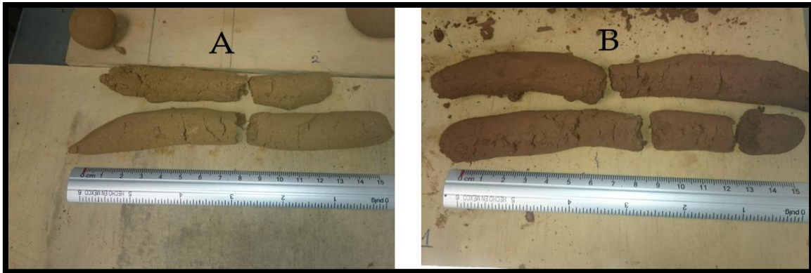
Ilustración 33 Prueba de plasticidad o de churro
