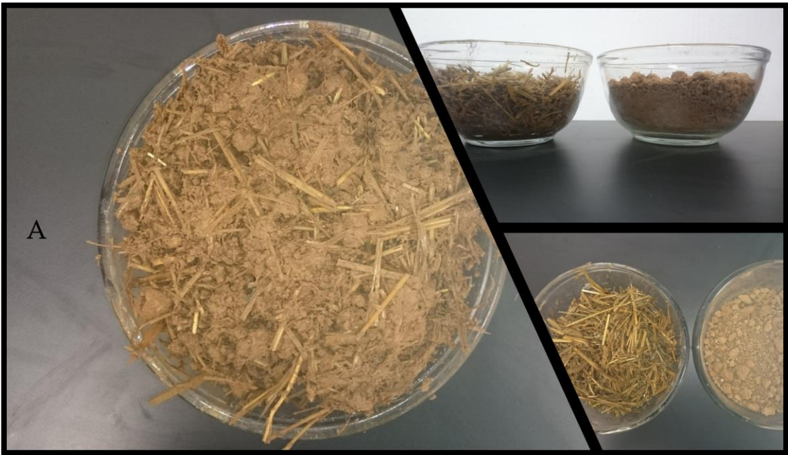
Ilustración 40 Mezcla tipo A con fibras de paja, proporción 1:1
