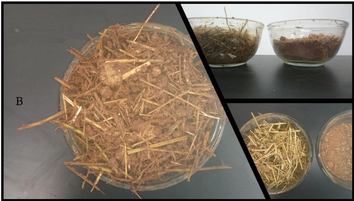
Ilustración 42 Mezcla tipo B con fibras de paja, proporción 1:1
