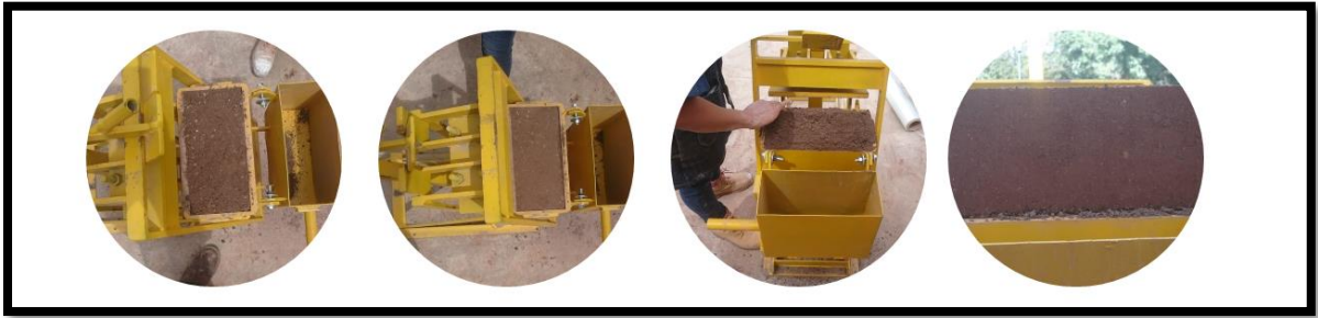
Ilustración 9 Técnica de Bloque de tierra compactada BTC
