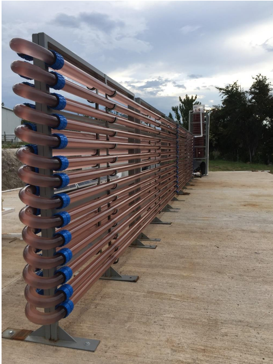
Figura 24 Fotobiorreactor(FBR) horizontal completo con cultivo de P. purpureum
