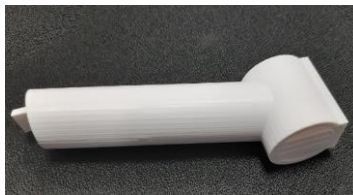
Ilustración 23. Brazo Drone 4 Motores Impreso
