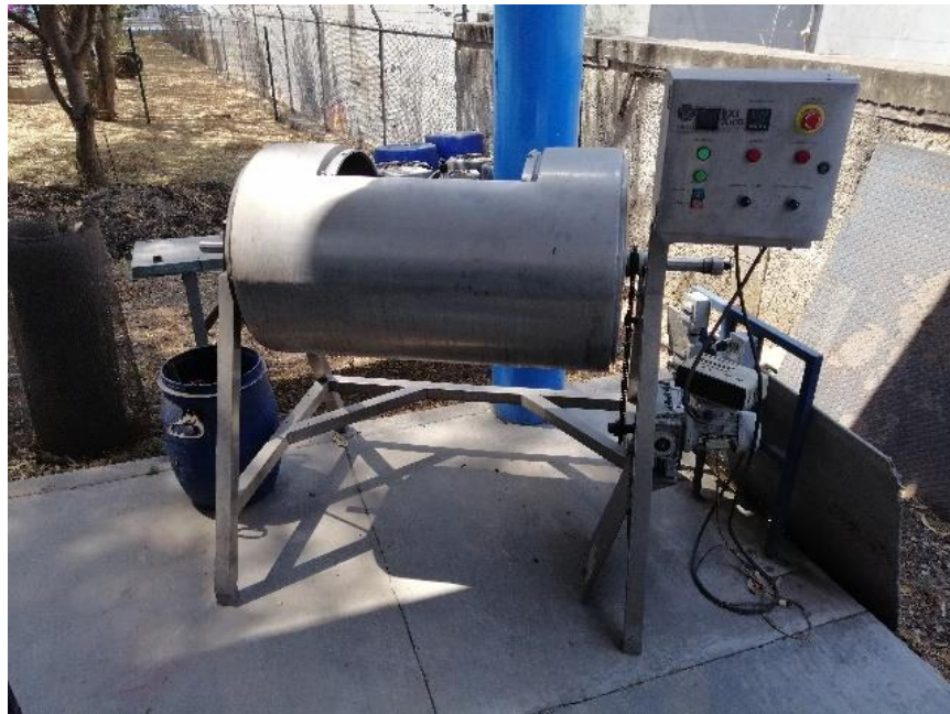
Figura 4. Prototipo de biorreactor de 300 L donado por la empresa InoxiMéxico
