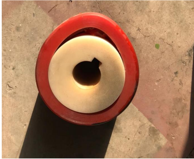
Figura 12. Primeras llantas con rin de Nylamid y área de contacto de poliuretano
