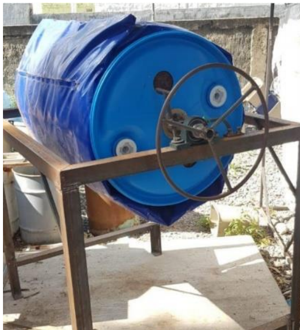
Figura 2. Segundo prototipo de biorreactor de 200 L, con rotación manual
