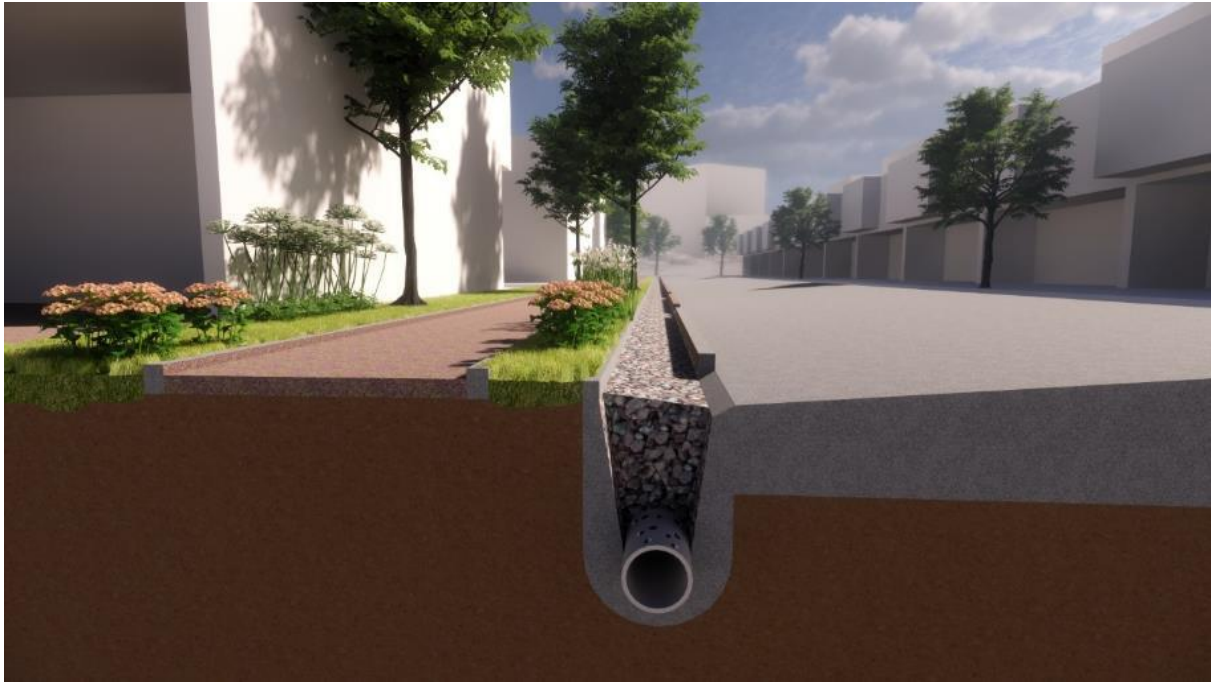
Figura 5-18 Corte trasversal de la trinchera filtrante propuesta para el interior del fraccionamiento.
