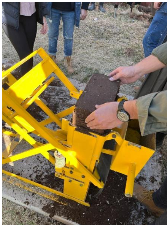
OBTENCIÓN DE BLOCK CON MEZCLA DE TIERRA, CEMENTO Y AGUA.
