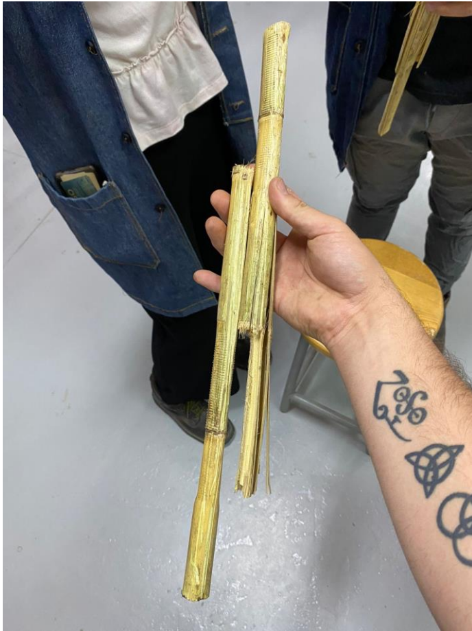
Imagen 3. Falla de la muestra I
