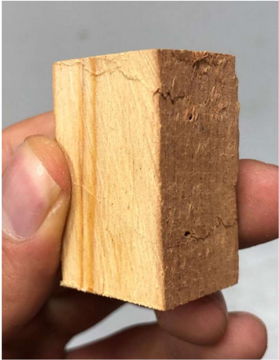
Imagen 5. Falla de probeta 1 de pino nacional.
