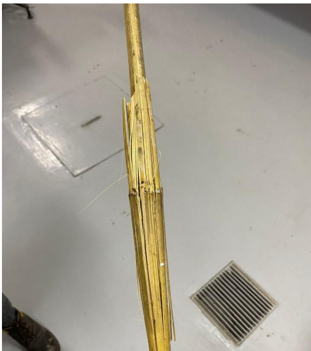
Imagen 2. Falla de la muestra M
