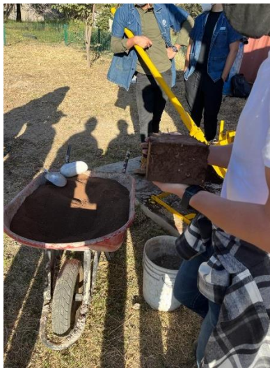
OBTENCIÓN DE BTC CON MEZCLA DE TIERRA, CAL Y AGUA.
