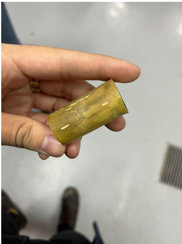
Imagen 4. Falla de muestra M2
