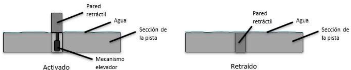
Imagen 3.3 Principio del sistema propuesto.
