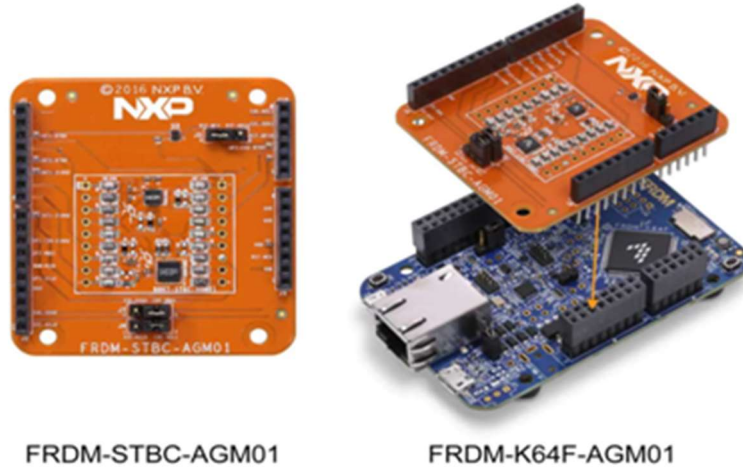
Unidad de medición inercial (IMU) y su montaje sobre la tarjeta de desarrollo K64F
