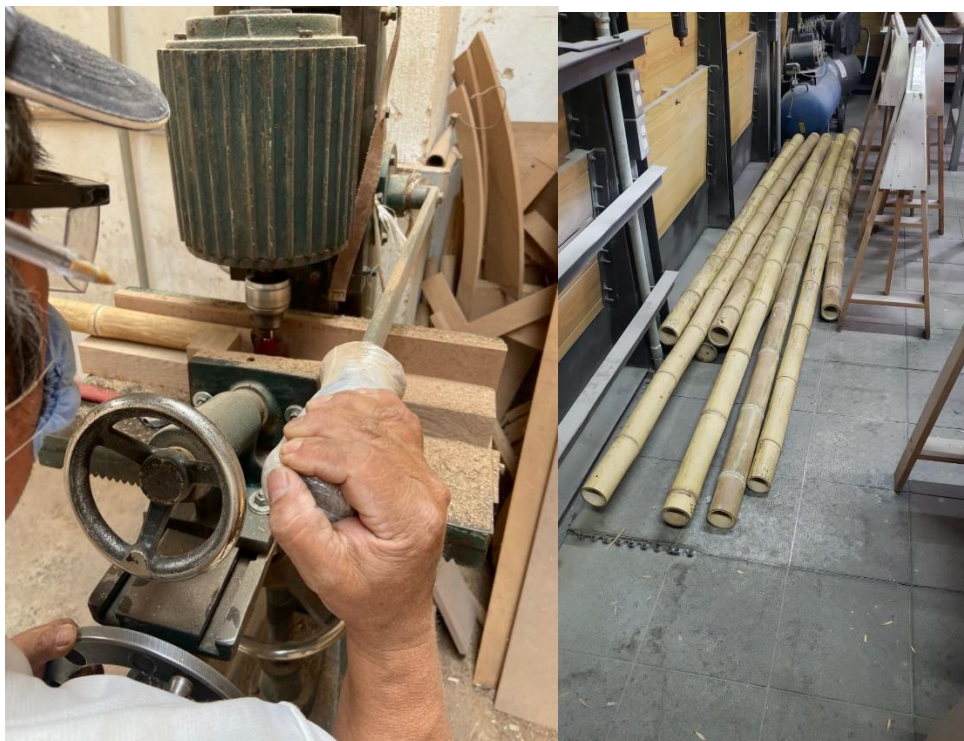
Ilustración 80. Trabajo en carpintería ITESO para corte de Culmos a medida de despiece 2022.
