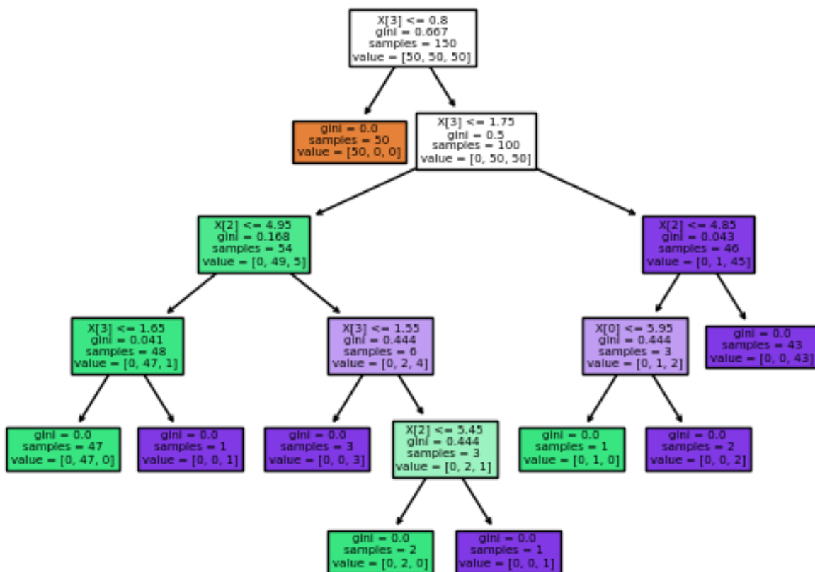
Figura 4. Ejemplo de un árbol de decisión tomado de la documentación de la librería para Python de aprendizaje automático, Scikit-learn: https://scikit-learn.org/stable/auto_examples/tree/plot_iris_dtc.html (1.10. Decision Trees, 2007)
