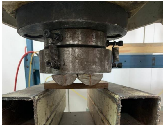
Figura 11 Ensayo de flexión a 4 puntos.
