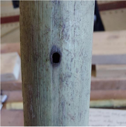
Figura 15 Pieza #5 con daño por parte de un insecto o animal
