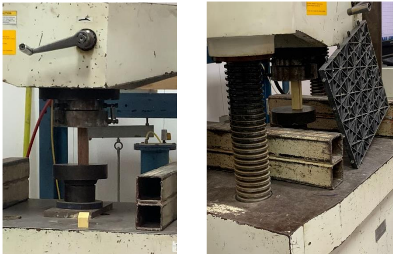
Figura 7 Ensayo de compresión axial a la fibra en prensa.
