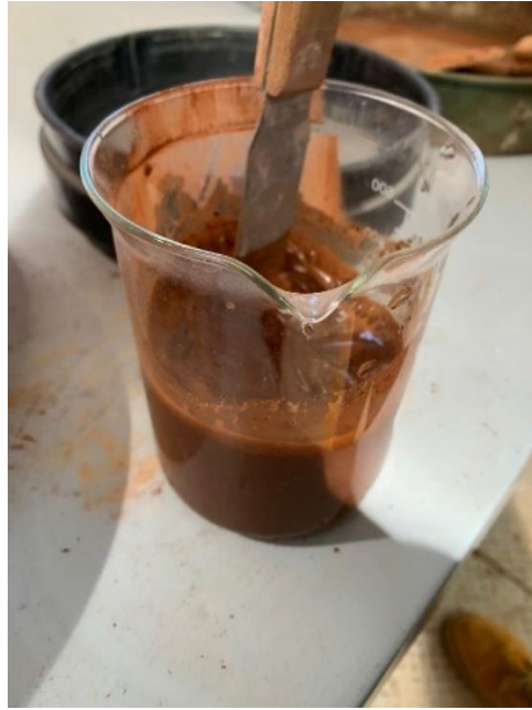
Figura 33 Disgregación de partículas usando agua
