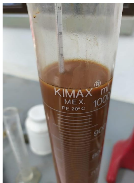
Figura 58 Hidrómetro en probeta de ensayo con muestra.
