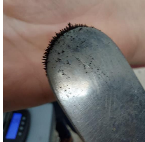
Figura 36 Material o posible contaminante durante el secado encontrado en la muestra 1
