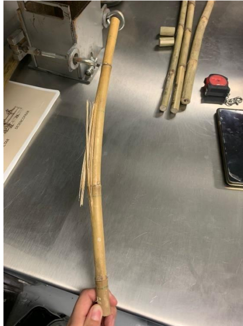
Figura 19 Falla presentada por flexión.
