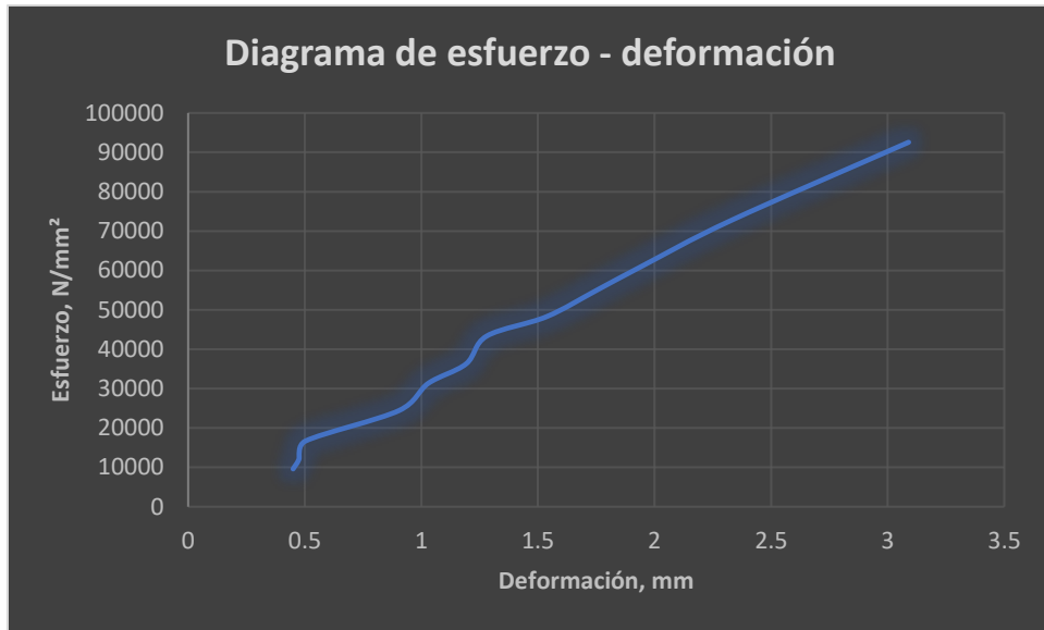
Gráfica 7 Diagrama de esfuerzo - deformación de "frijolillo".
