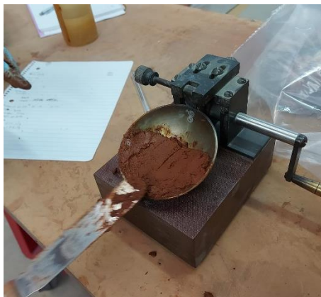
Figura 44 Colocación y ranurado de muestra para límite líquido
