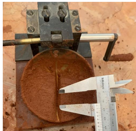
Figura 44 Colocación y ranurado de muestra para límite líquido
