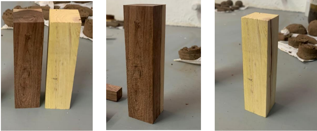
Figura 6 Probetas 1 y 2 dimensión: sección 30 x 30 mm, largo 120 mm.
