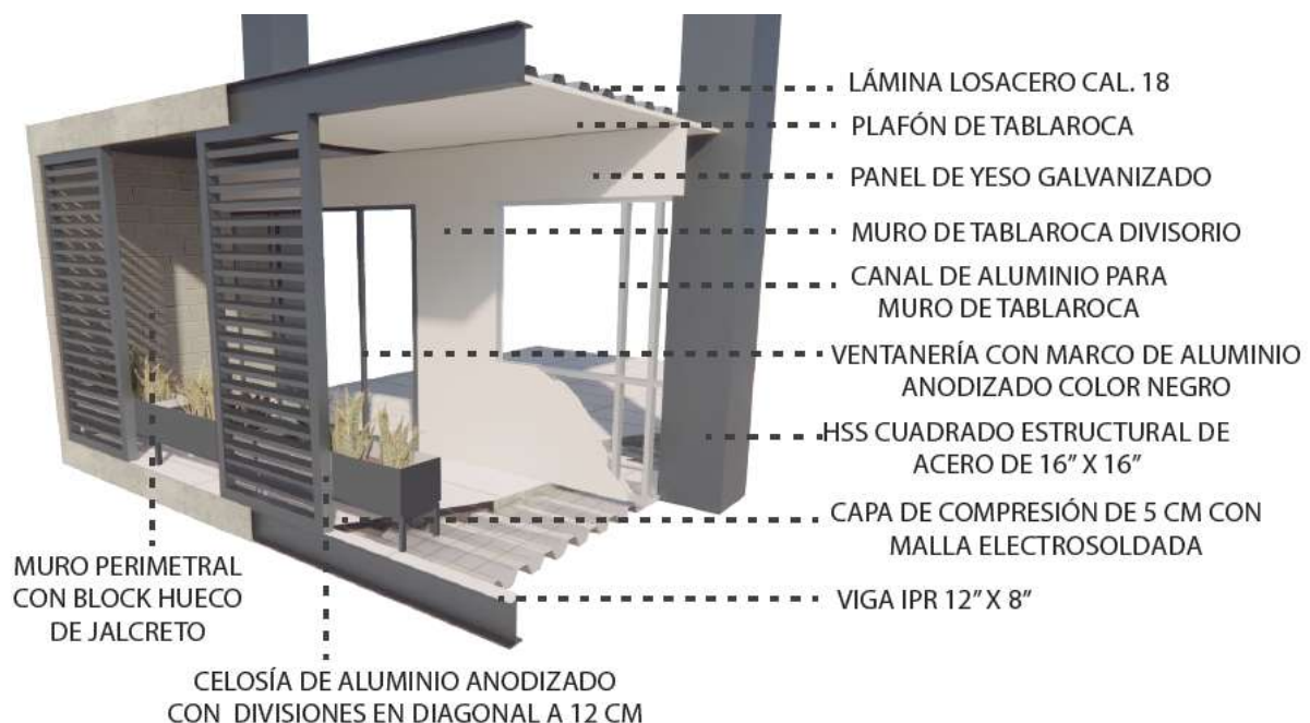
Figura#38 Corte estructural con materialidad
