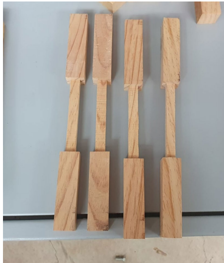
Especímenes prismáticos para prueba de compresión simple. (elaboración propia)
