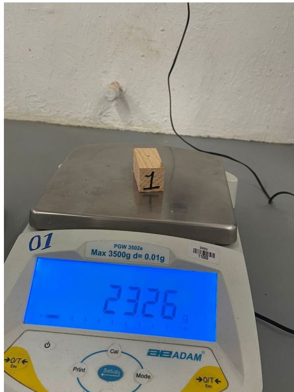
Determinación de la masa de los especímenes. (elaboración propia)
