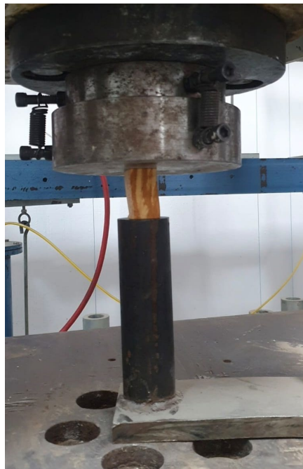
Configuración del ensaye y espécimen siendo sometido a carga axial paralela a la fibra. (elaboración propia)
