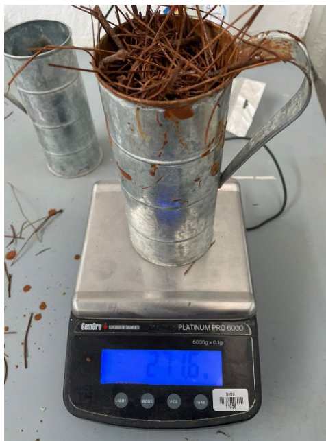
Obtención de masa del aislante térmico. Elaboración propia
