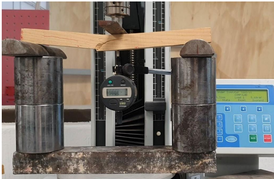
Probeta No.4 al momento del fallo en la prueba de flexión. (elaboración propia)
