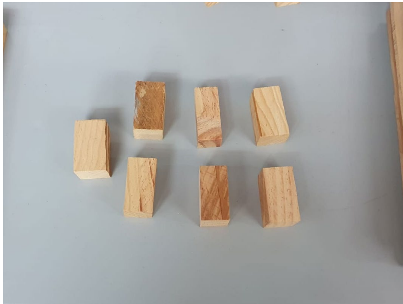
Especímenes prismáticos para prueba de compresión simple. (elaboración propia)
