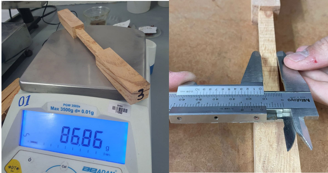
Determinación de la masa y medidas de los especímenes. (elaboración propia)
