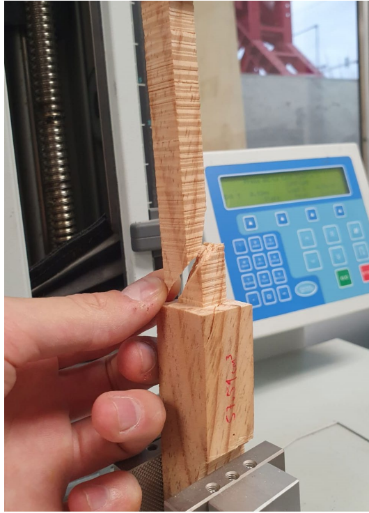
Falla a tensión de la probeta No.1. (elaboración propia)
