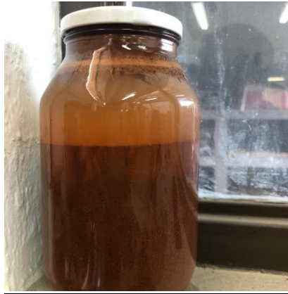
Ilustración 2: Prueba de la botella para identificación de contenido orgánico. En la imagen se muestra una botella que requiere seguir agitando hasta que el agua quede transparente.
