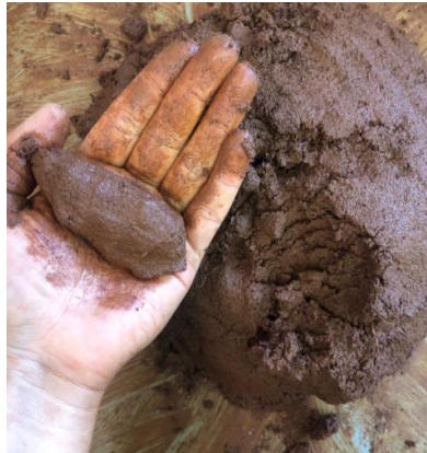
Ilustración 5: Este es un ejemplo de sobresaturación de la muestra y cómo NO debe de observarse la humedad en la tierra.
