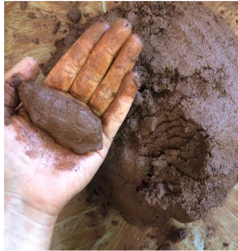
Ilustración 3: Este es un ejemplo de sobresaturación de la muestra y cómo NO debe de observarse la humedad en la tierra.
