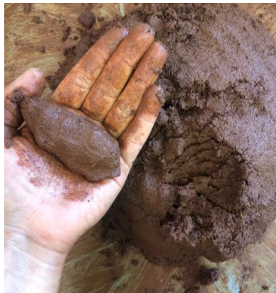
Ilustración 4: Este es un ejemplo de sobresaturación de la muestra y cómo NO debe de observarse la humedad en la tierra.
