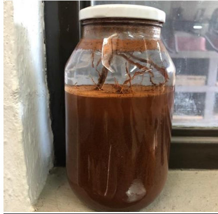
Ilustración 1: Prueba de la botella, identificación de distintos estratos. Lista para lectura fina, agua completamente transparente.
