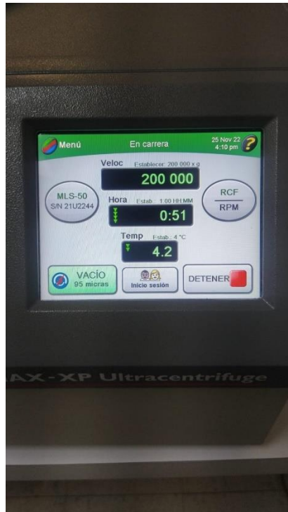
Anexo 4. Parámetros de la ultracentrifugadora del CIBO en el paso 8, protocolo 1
