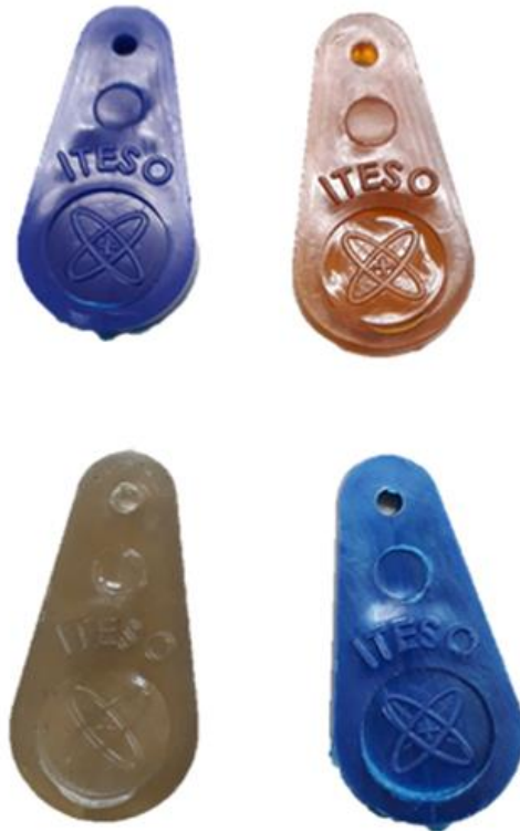
Imagen 40. Resultados de las pruebas de inyección de diferentes materiales.
