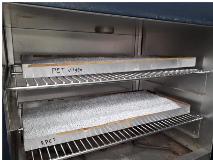
Imagen 33. PET Virgen y RPET dentro de desecador, para el proceso de secado.
