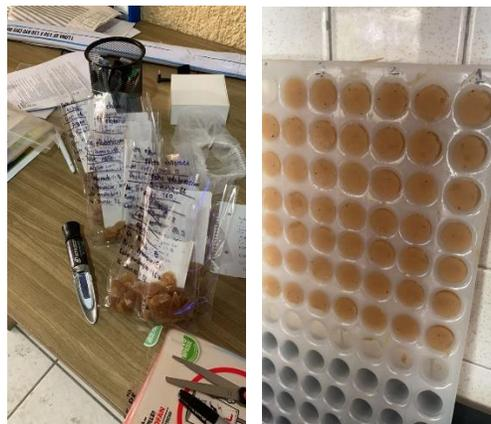
*Figura 9. Empacado de pruebas (izquierda) y desmoldado de pruebas (derecha).*
