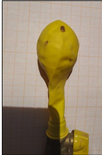
Figura 26. Medición del diámetro mayor de un globo con una hoja milimétrica.
