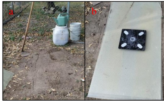
Figura 22. Nivelado con para el proceso de pesado(a) y la lámina para dar mayor soporte (b).
