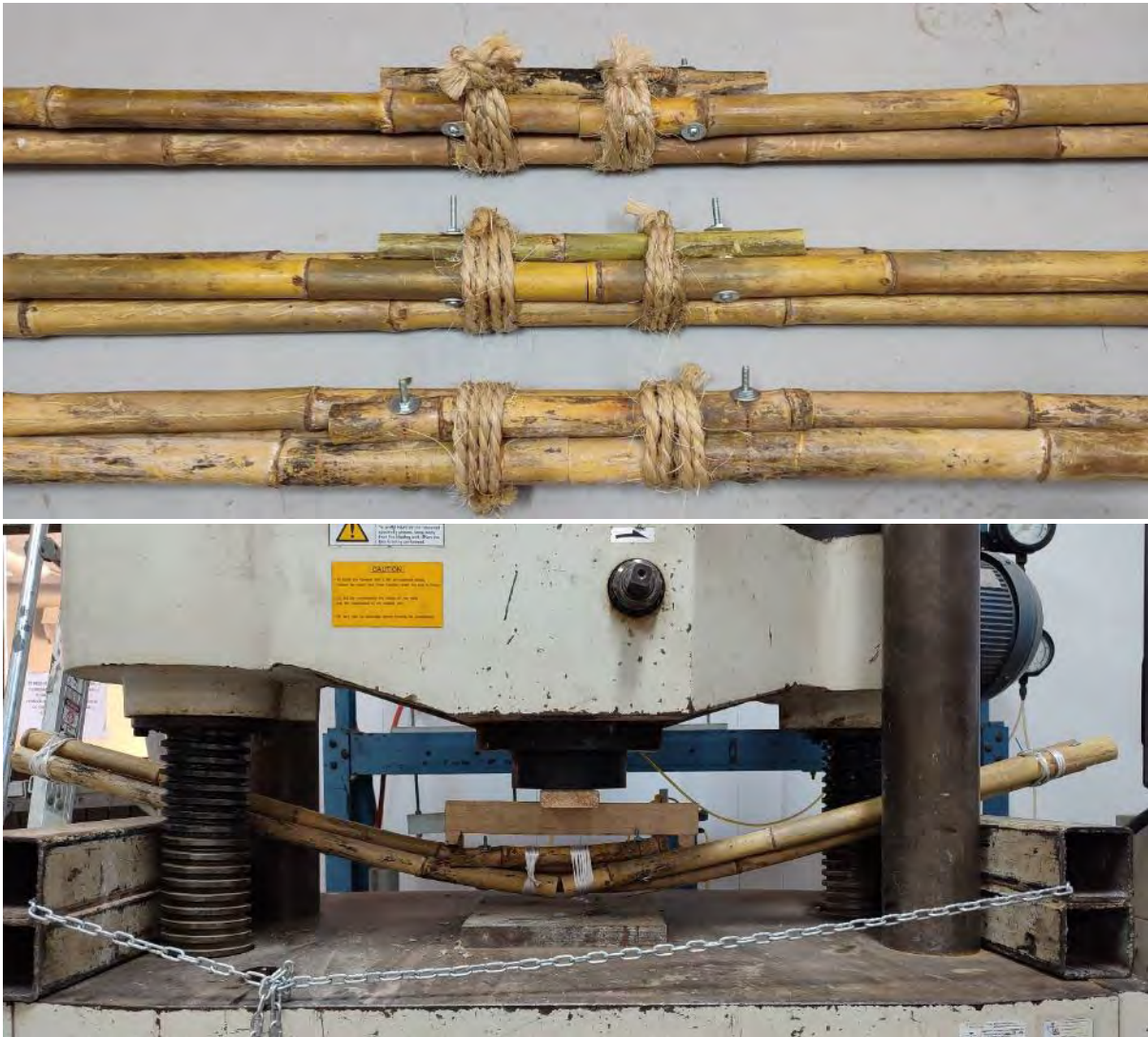
Figura 56-1. Unión ensayada para zunchos de Ixtle.
