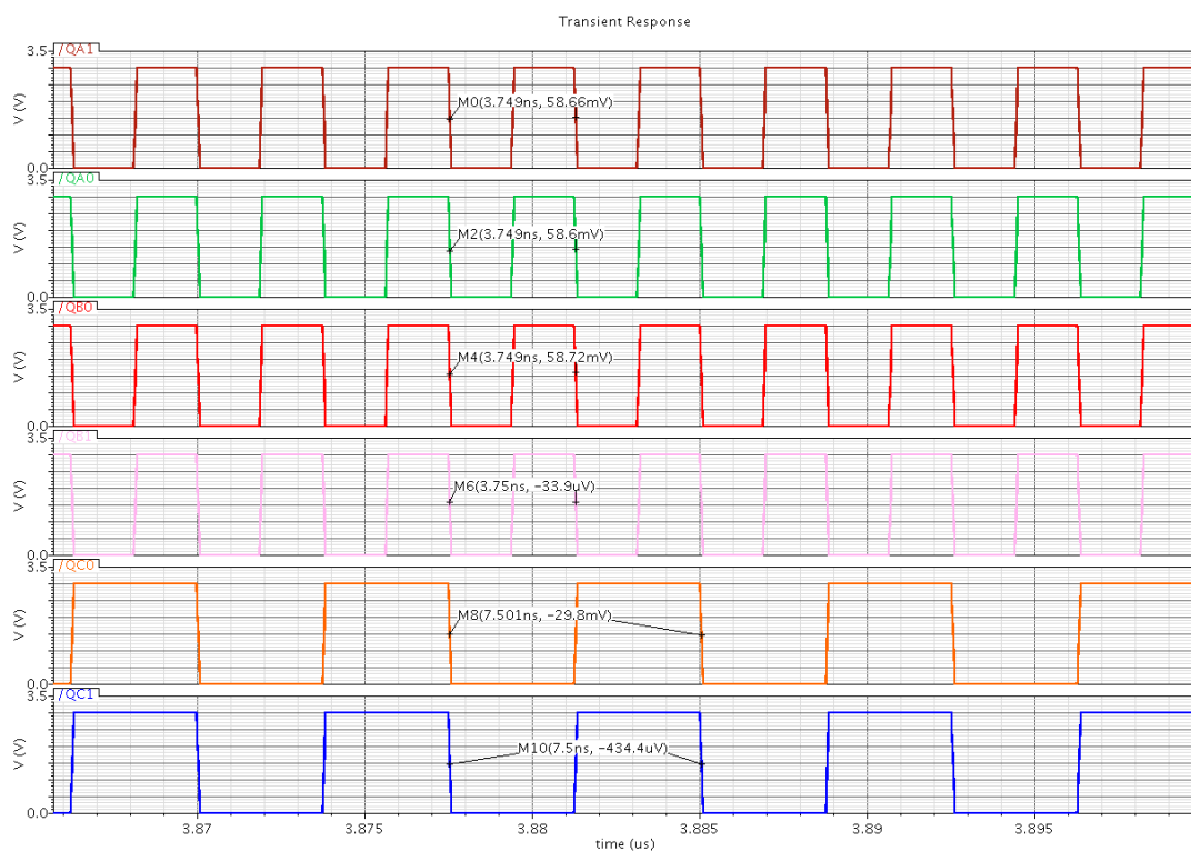
Figura 23: simulación transitoria del Soc, donde se observa las señales de salida Q0A, Q1A, Q0B, Q1B, Q0C, Q1C
