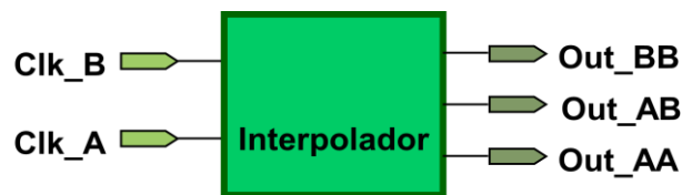
Ilustración 1 Esquema Interpolador de 2 a 3 señales
