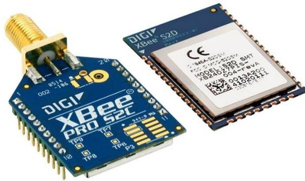
Una parte importante de estos módulos es la forma que pueden trabajar dentro de una red, pueden ser activados como coordinador, router o End Device.
