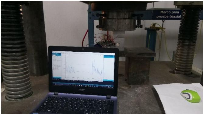
Figure 18 prueba de celda de carga
