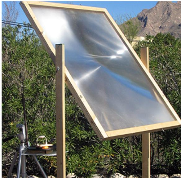
Figura 6. Lente Fresnel Fuente: *Coscinassolares.blogspot.mx*
