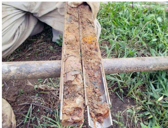
Muestra de suelo extraída mediante prueba SPT
