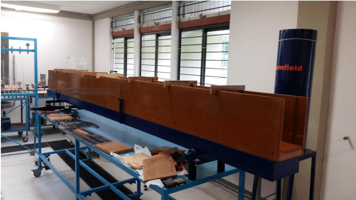
**Imagen izquierda 10:** Instalación del riel de acero y colocación del cajón experimental. (Elaboración propia).
