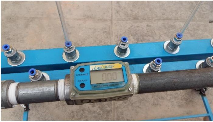
**Imagen 31:** Medidor de gasto utilizado (Elaboración propia).
