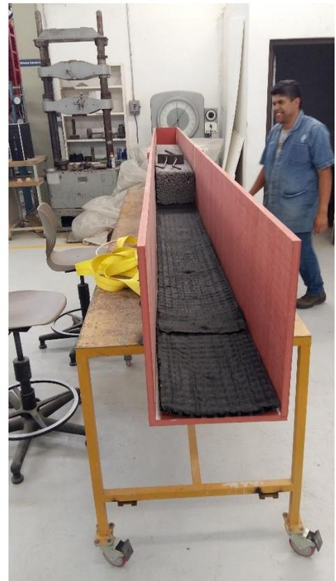
**Imagen derecha 29:** Colocación de Geocompuesto Delta-Drain 2000 (Elaboración propia)
