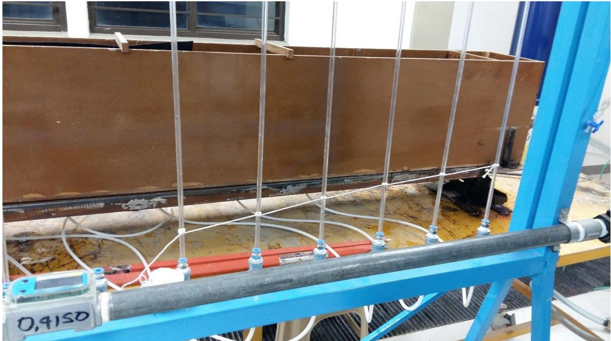
**Imagen 22:** Medición de cargas hidráulicas a lo largo del sistema (Elaboración propia).
