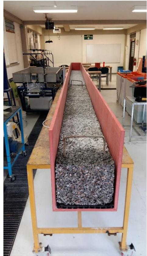
**Imagen 32:** Colocación de vigas de concreto permeable en modelo (Elaboración propia).
