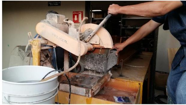
**Imagen 16:** Corte con disco de viga de concreto permeable (Elaboración propia).
