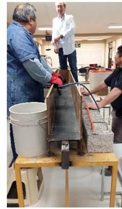
**Imagen 19:** Engrapado de la geomembrana al cajón (Elaboración propia).
