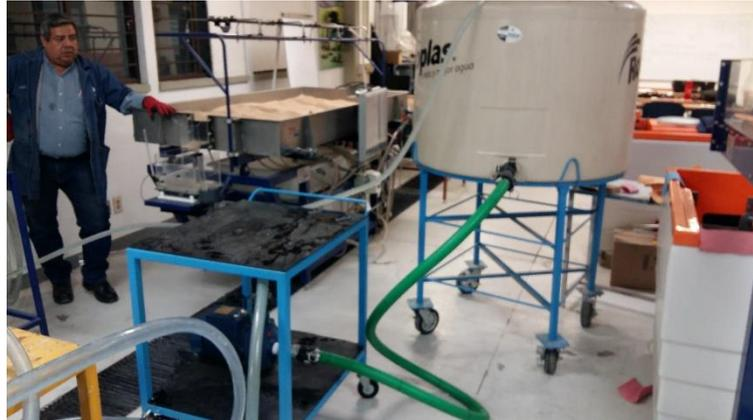
**Imagen 24:** Bomba y tanque de agua conectados al modelo experimental (Elaboración propia).
