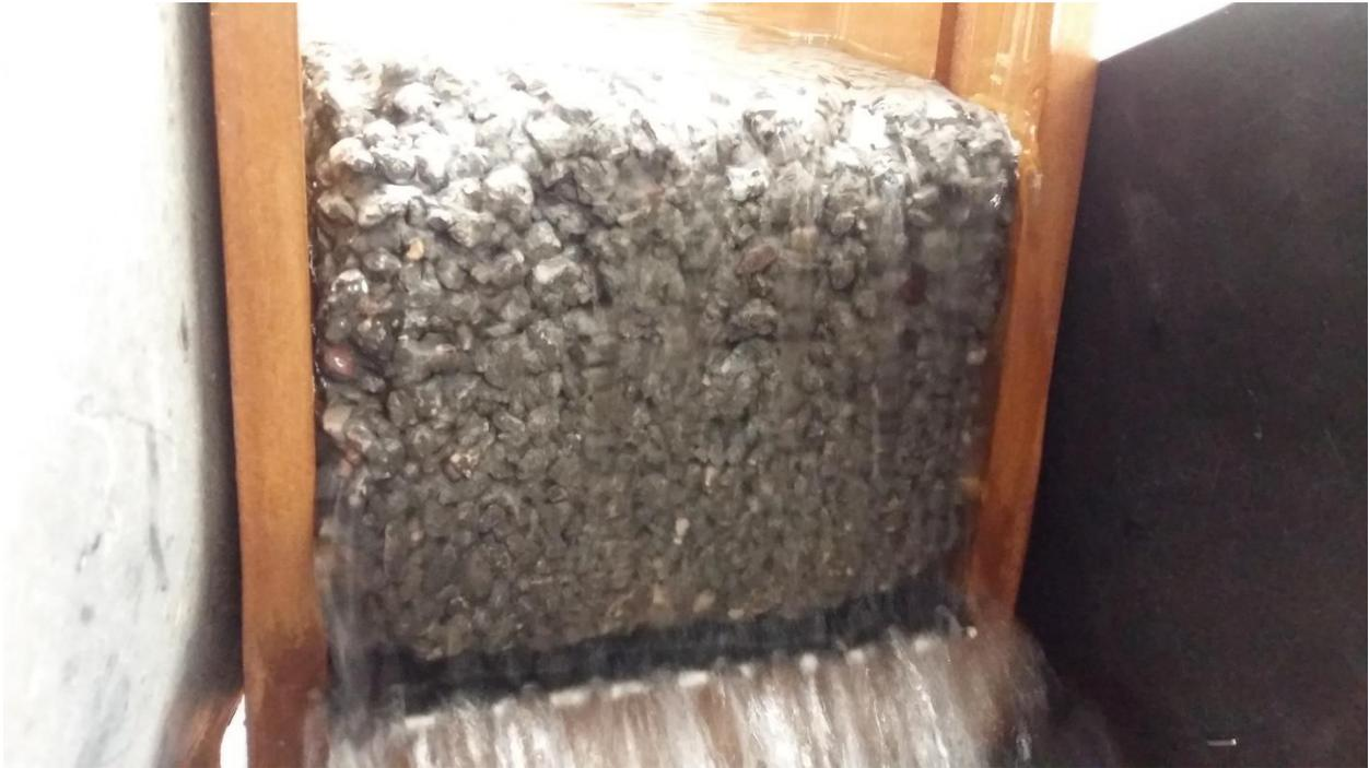
**Imagen 44:** Salida del flujo por el geocompuesto y por el cuerpo del concreto permeable (Elaboración propia).
