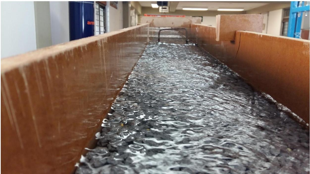
**Imagen 40:** Flujo de agua por la superficie del concreto permeable (Elaboración propia).
