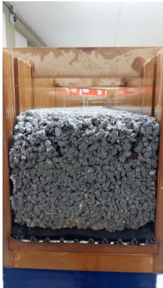
**Imagen 38:** Corte transversal del sistema, geocompuesto por debajo del concreto permeable (Elaboración propia).
