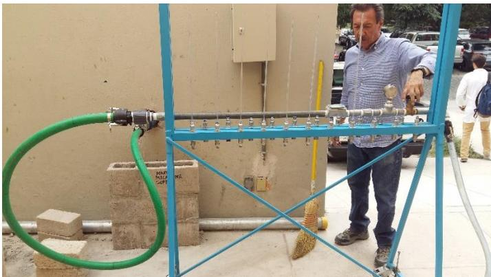
**Imagen 30:** Calibración del medidor de gasto (Elaboración propia).
