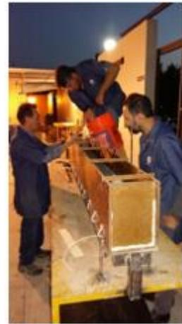
**Imagen 18:** Vaciado de agua por medio de una cubeta para obtener un estimado de la porosidad (Elaboración propia)
