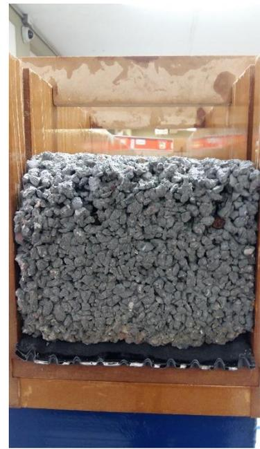
**Imagen derecha 13:** Corte transversal del sistema, geocompuesto por debajo del concreto permeable (Elaboración propia).
