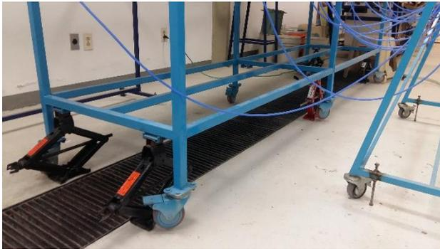
**Imagen 36:** Gatos hidráulicos colocados para nivelar el modelo experimental (Elaboración propia).
