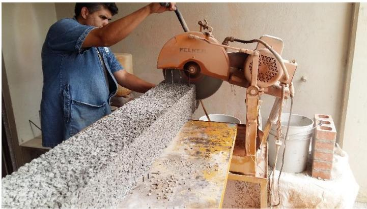
**Imagen 28:** Cortado de viga de concreto permeable (Elaboración propia).
