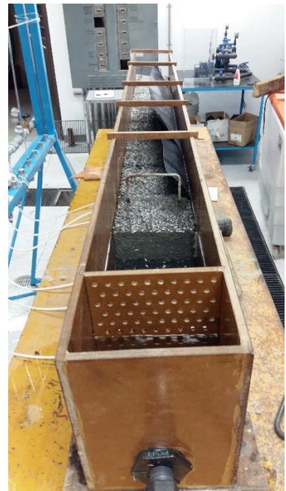
**Imagen 23:** Modelo funcionando con carga variable y pendiente cero (Elaboración propia).
