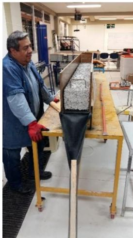
Se conectó el modelo a una bomba y a un tanque de agua, el cual a su vez estaba conectado a una llave del laboratorio, lo cual hizo posible tener un gasto constante. Para la medición del gasto entrante, se contó con un medidor a la entrada del agua en el modelo, el cual mide el flujo de agua que transita por la viga. Además, se conectó un piezómetro por medio de mangueras a diferentes puntos de la viga, con lo que se pretende observar la carga hidráulica a lo largo del sistema.
