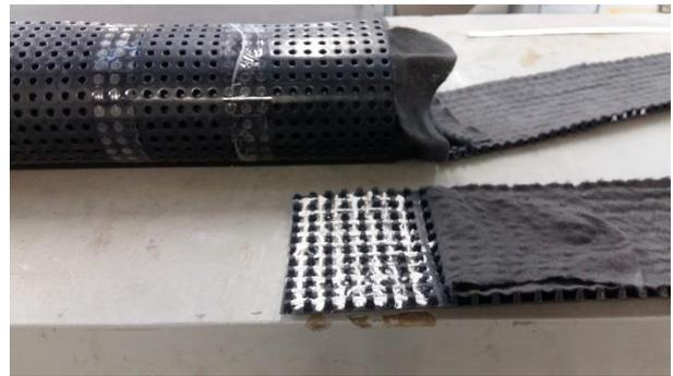
**Imagen 27:** Geocompuesto Delta-Drain 2000 (Elaboración propia).
