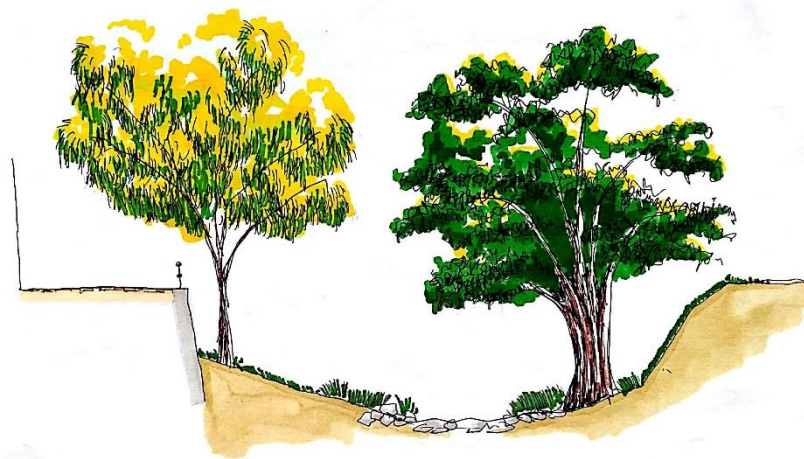
CROQUIS 2. La sección del cauce deberá permitir el desarrollo de los bosques de galería, lo mismo dentro de los límites del cauce que en la ribera.
