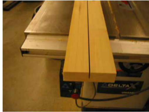
Figura 18:: Corte para aliviar la presión, (FP Innovations , 2013)
