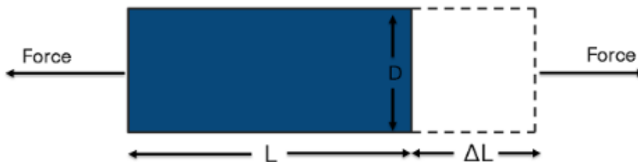
Figura 39: deformación unitaria con fuerzas axiales, National Instruments
