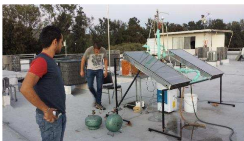
Figura 1. Fotografía de sistema de secadores solares híbridos en operación.
