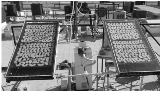
Fig.1. Secadores Construidos e Instalados, Durante el Proceso de Secado de Piña.
