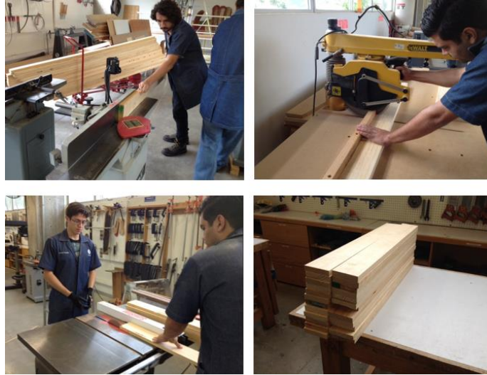
Figura 35. Preparación de las tablillas (Elaboración propia).
