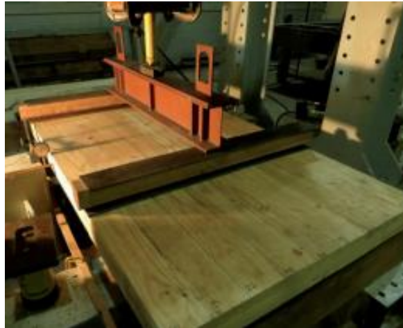
Figura 26. Ensayo de flexión en panel de CLT tipo losa en Chile. (González et. al, 2015)
