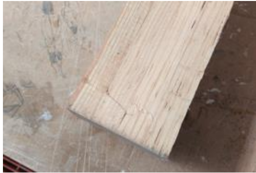
Figura 44. Aplastamiento de la columna 1 (Elaboración propia).
