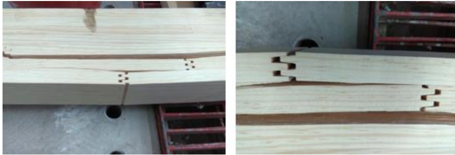
Figura 45. Modo de falla de la viga de madera laminada encolada (Elaboración propia).
