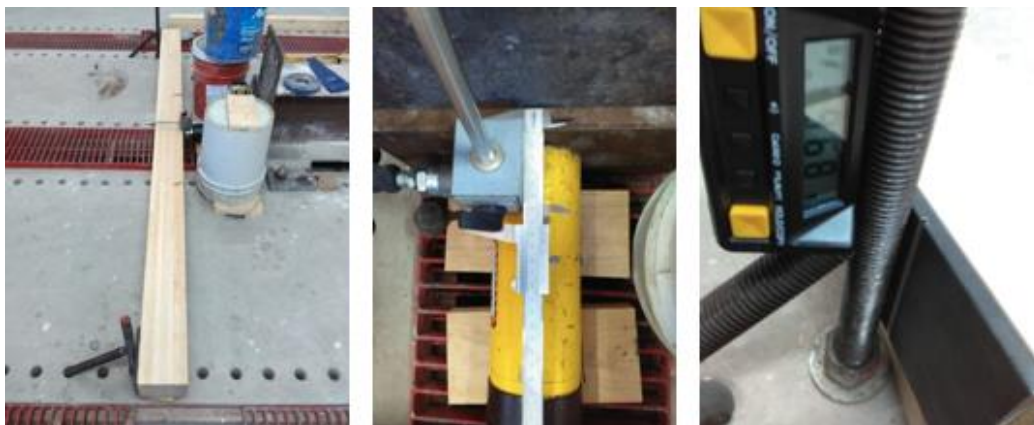
Figura 42. Configuración del ensayo a flexión de una viga de madera laminada encolada (Elaboración propia).
