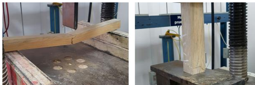
Figura 29. Configuración de los ensayos a flexión y compresión según la norma ASTM D-143 (Elaboración propia).
