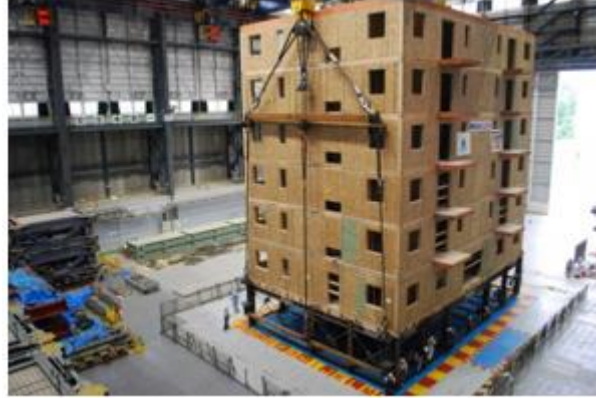
Figura 2. Ensayo sísmico de un edificio de madera contralaminada en la plataforma E-Defense. (AlaTown, 2015).
