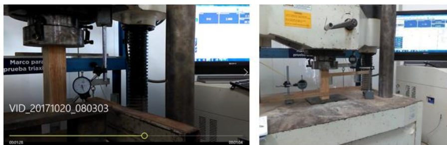
Figura 30. Ensayo adaptado para obtener el MOEc (Elaboración propia).
