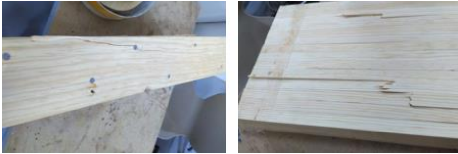
Figura 47. Modo de falla de la losa de madera laminada clavada (Elaboración propia).
