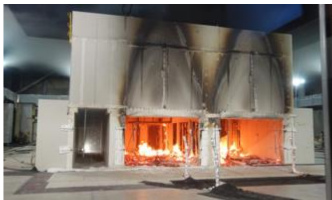
Figura 5. Prueba de resistencia al fuego en un edificio de madera contralaminada (Bland, 2017).
