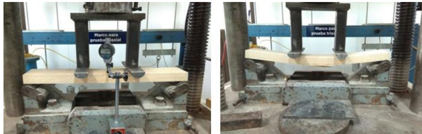
Figura 31. Ensayos para determinar el MOE y la capacidad de flexión (Elaboración propia).
