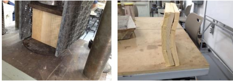
Figura 40. Ensayo de compresión de muros de madera contralaminada (Elaboración propia).
