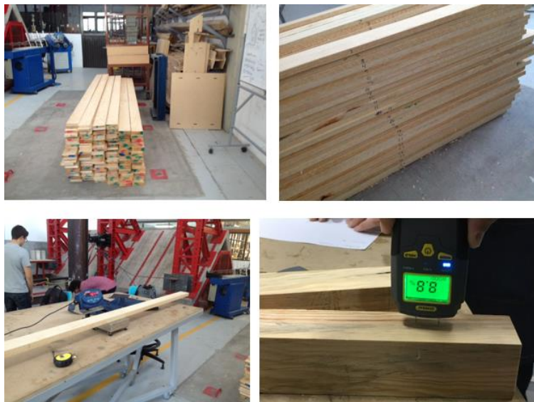
Figura 28. Proceso de clasificación por densidad (Elaboración propia).
