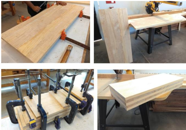
Figura 37. Fabricación de losas de madera contralaminada (Elaboración propia).
