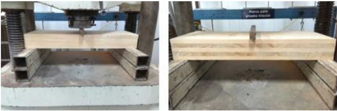
Figura 43. Configuración del ensayo a flexión de las losas (Elaboración propia).
