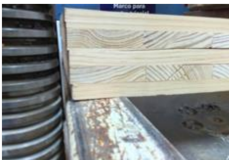
Figura 46. Modo de falla de la losa de madera contralaminada (Elaboración propia).
