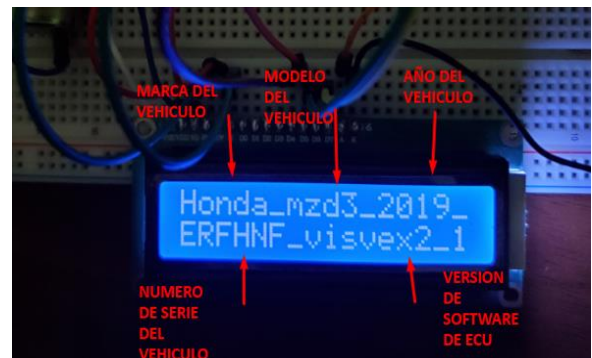
Fig. 5. Visualización de datos del vehículo en la pantalla
