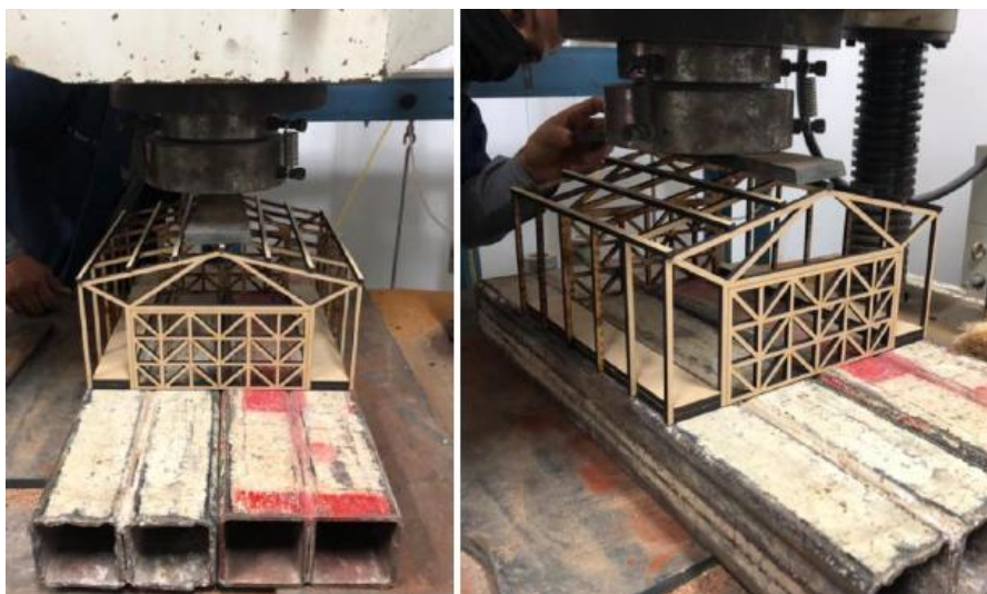
Figura 139. Prueba de modelo de huerto escolar en prensa universal.
