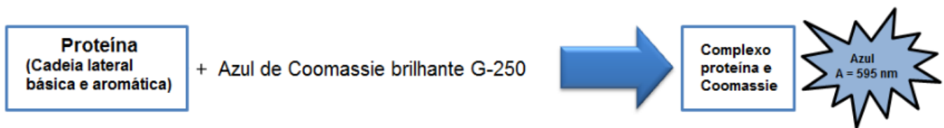
Figura 2.21 – Mecanismo de reacción del ensayo de Bradford [60].
